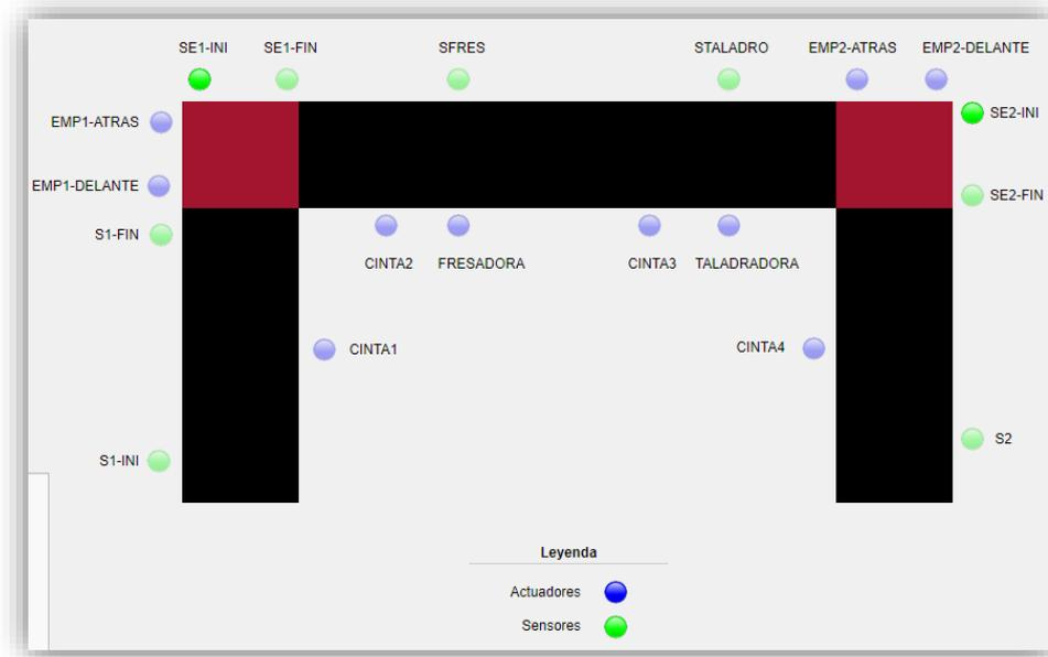
*Figura 2.1.7. Diagrama implementado en el SCADA de la línea indexada junto con todas las bombillas*
