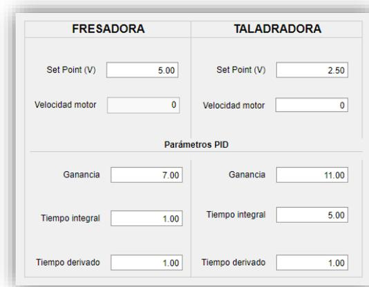
Figura 2.6. Sección de control y visualización en la aplicación SCADA de los parámetros PID, Set Points y velocidades
