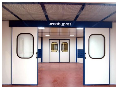
Divisoria de separación entre aplicación y secado
