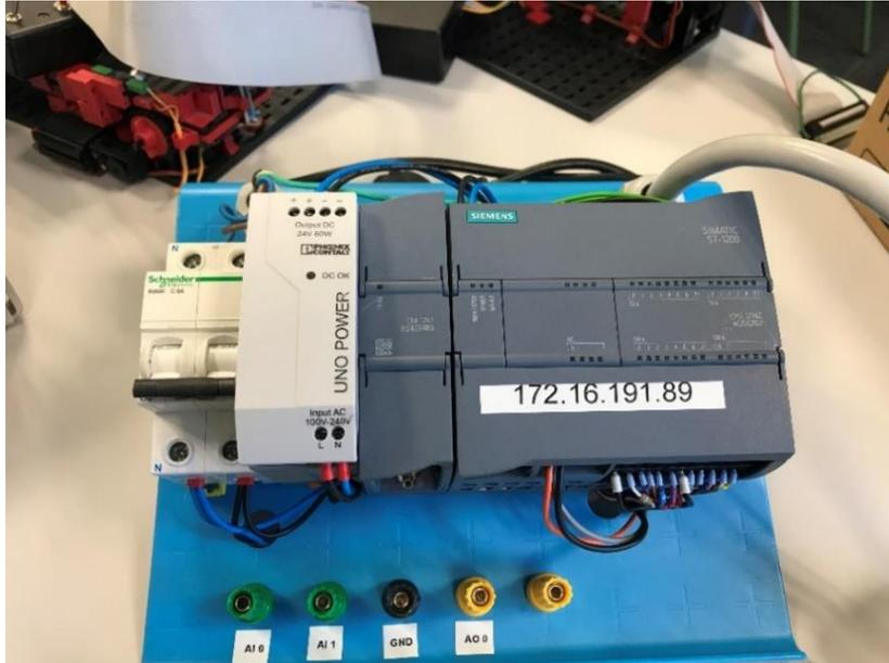
Ilustración 16. S7-1200 CPU 1214C instalado en el laboratorio de automatización del DISA
