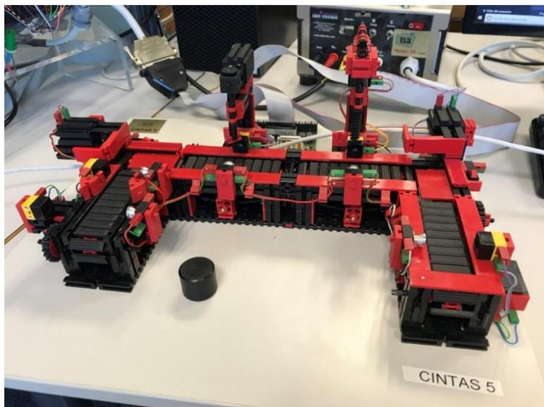
*Ilustración 19. Prototipo de proceso de fresado y taladrado*
