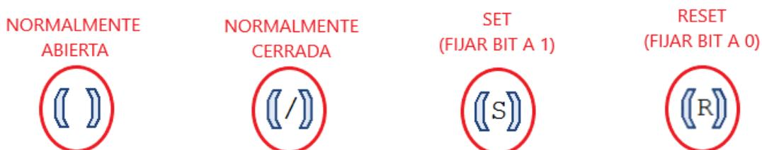
Ilustración 9. Tipos de bobinas en diagrama ladder
