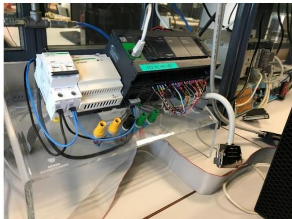
Ilustración 15. Autómata TM241CE40R instalado en el laboratorio de automatización del DISA
