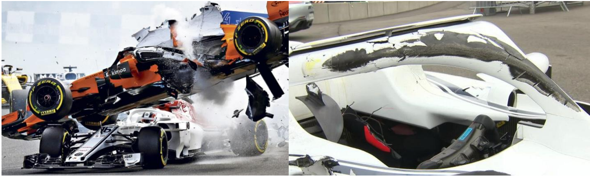
a) Momento en el que el coche de Fernando Alonso colisionó contra el Sauber de Charles Leclerc [8]; b) Estado del Halo tras el impacto [9].
