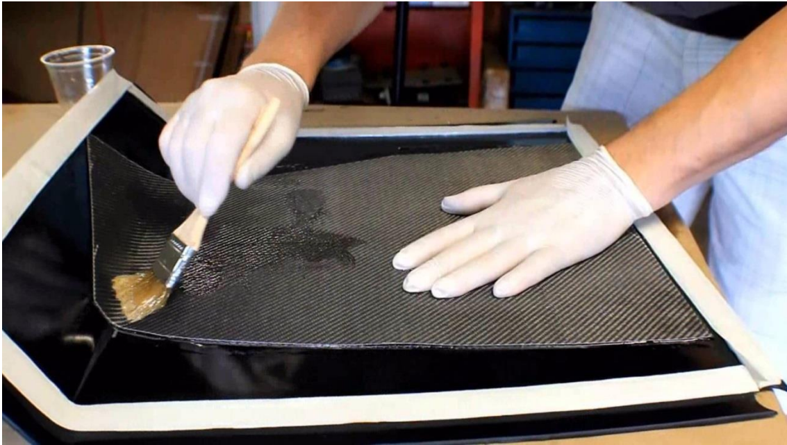
Figura III.69. Aplicación de resina epoxi sobre fibra de carbono [16].
