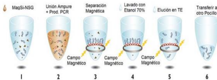
Figura 5. Esquema de purificación con Magsi-Prep. Imagen extraída de Seda, 2018.
