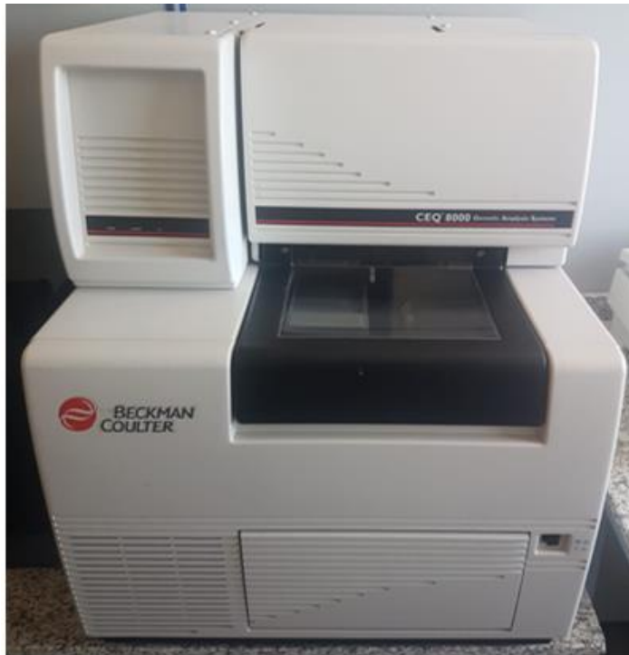
Figura 8: Imagen del secuenciador CEQ 8000 (Beckman Coulter, Brea, CA, EEUU) empleado durante la secuenciación de los microsátélites de interés.
