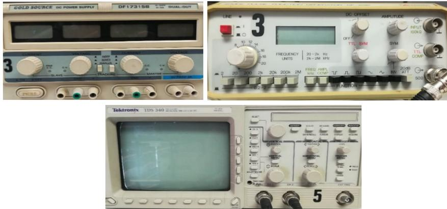
Ilustración 2: a) Fuente de alimentación, b) Generador de funciones y c) Osciloscopio.
