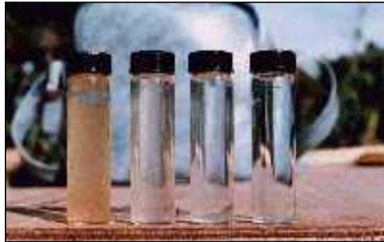
Figura 2.2. Comparación entre muestras de agua cruda y tratada con *Moringa Oleifera*.
