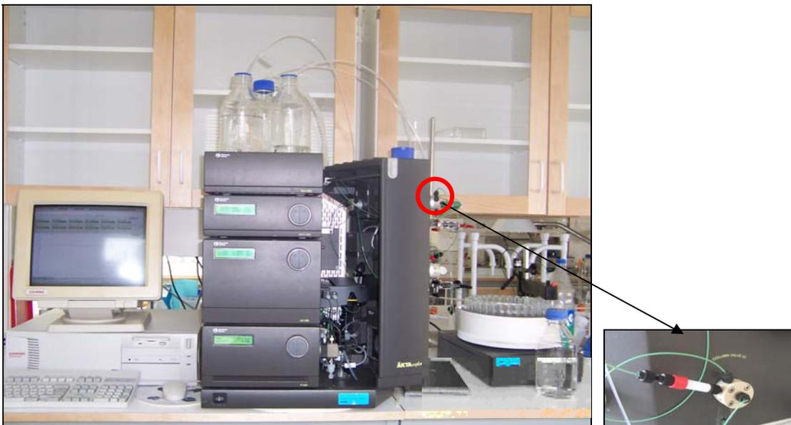
Figura 4.5 Equipo Äkta de purificación. Detalle de la columna CM Sepharose™
