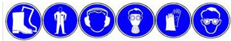
Figura 32. Señales obligatorias en los puestos de trabajo de los equipos de protección individual (EPI) que hay que utilizar.
