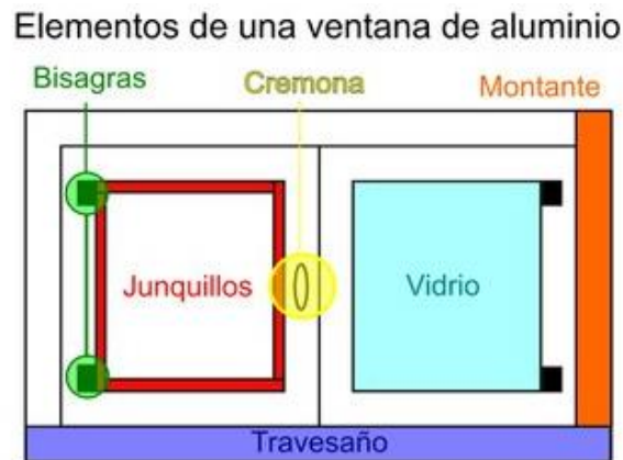
Figura 12. Despiece de una ventana.
