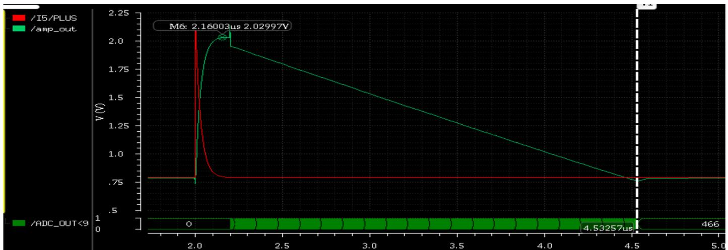
Ilustración 62: Tiempo de adquisición Full Scale
