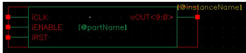
Ilustración 49: Contador de 10 bits
