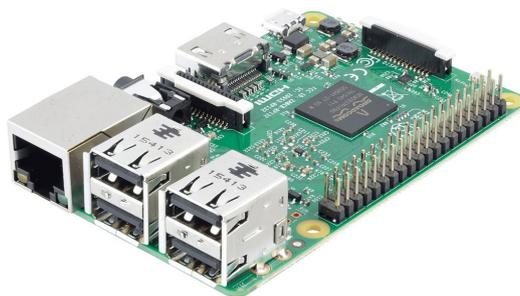
**Figura 2.5** Ordenador de placa reducida Raspberry pi 3 model B.
