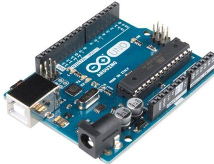
**Figura 2.4** Microcontrolador Arduino UNO.
