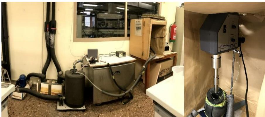
**FIGURA 2.** Montaje de equipo de extracción con ultrasonidos
