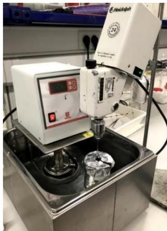
**FIGURA 1.** Montaje de equipo de extracción convencional
