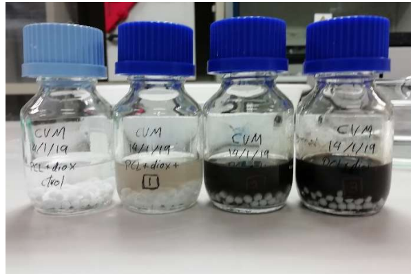
Ilustración 14. Frascos con sus cantidades de PCL, dioxano y GO correspondientes a cada tipo de muestra.
