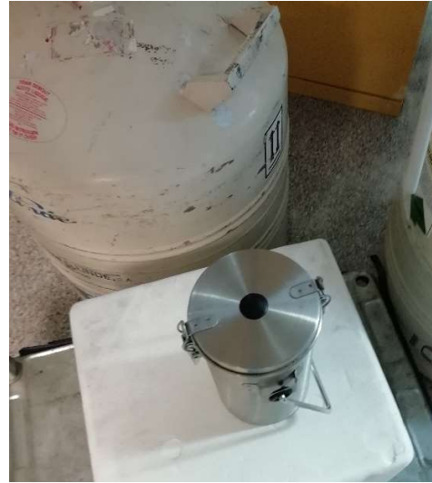
Ilustración 16. Bombona y recipiente de contención para el N 2 (l).
