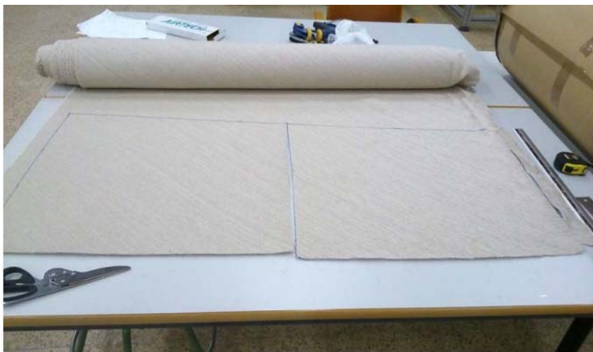
Figura 143. Imagen de preparación y corte de diversas capas de fibra de yute.
