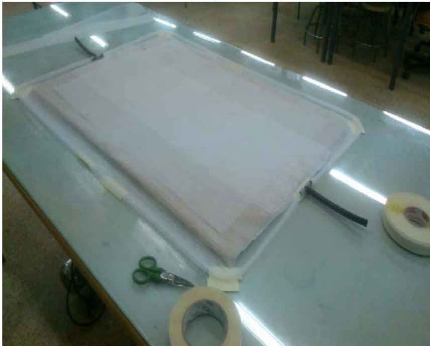
Figura 147. Colocación del tubo (PE) - uniones del tipo T - tubería continuá.
