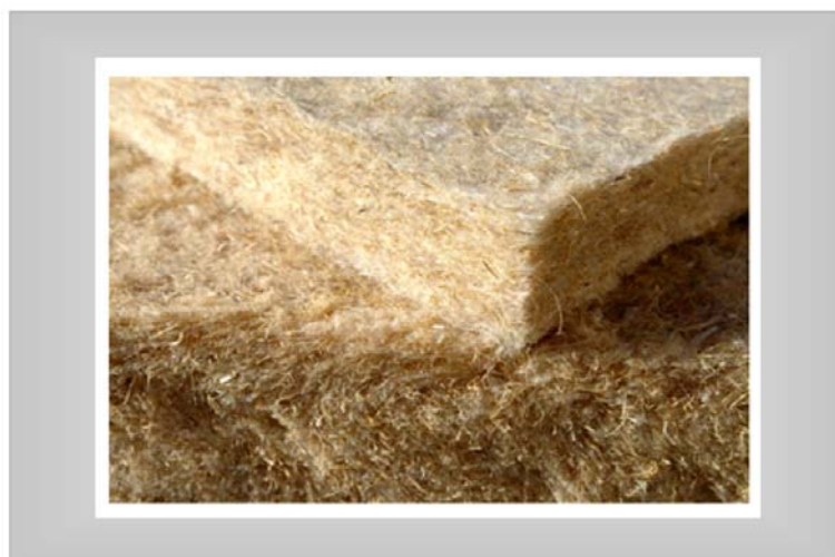
Figura 24. Imagen de la manta aislante del cáñamo.
