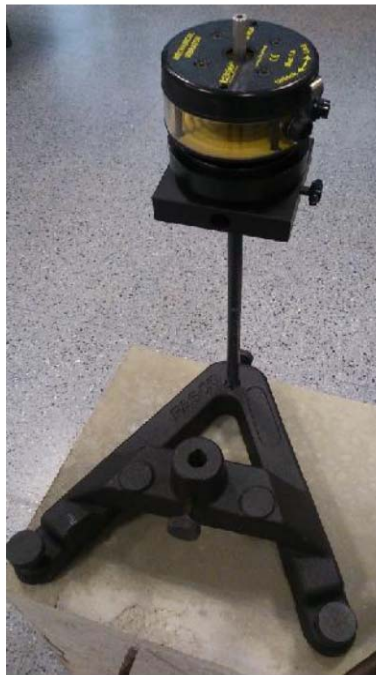
Figura 126. Imagen del Shaker (vibrador electrodinámico). Utilizado para el ensayo de vibración forzada.
