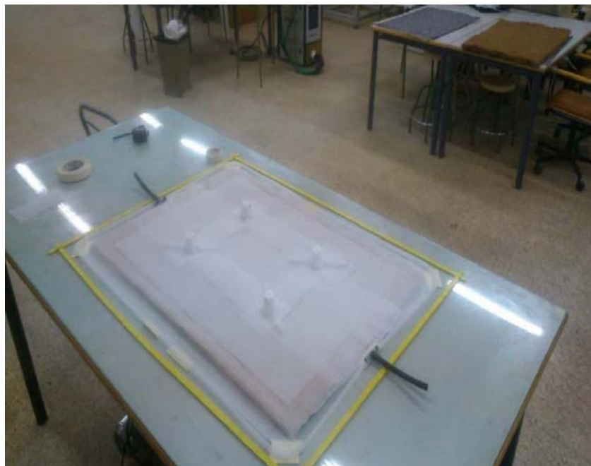
Figura 149. Colocación de los canales de entrada de resina.
