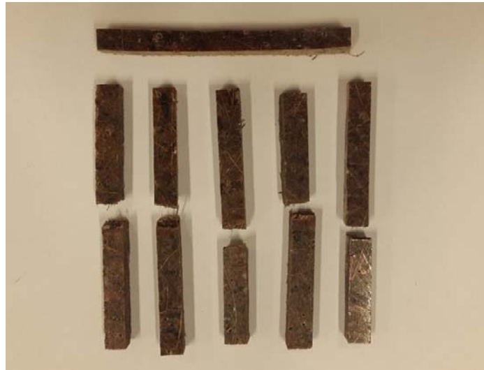
Figura 227. Imagen de las roturas en las probetas del “green composite” de coco con bioresina una vez finalizado el ensayo de impacto.
