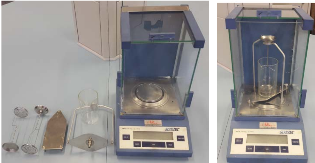
Figura 156. Imágenes de la balanza hidrostática y sus componentes para la obtención de las densidades de los composites.
