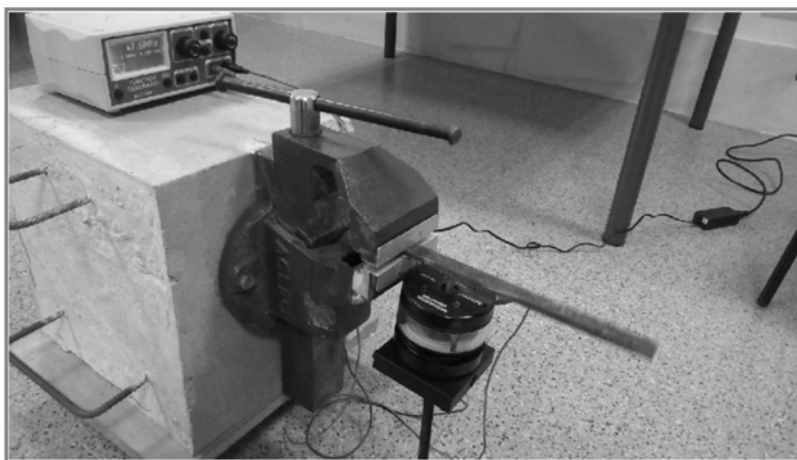
Figura 60. Imagen del ensayo de vibración forzada con shaker.
