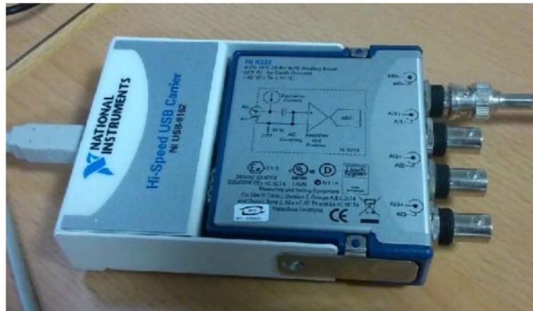
Figura 129. Tarjeta electrónica de frecuencia de la casa National Instruments.
