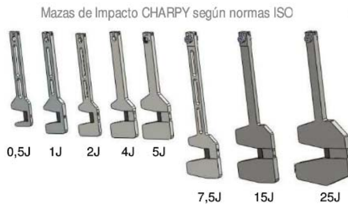
Figura 123. Imagen del tipo de masas de impacto aplicadas a la normativa ISO.
