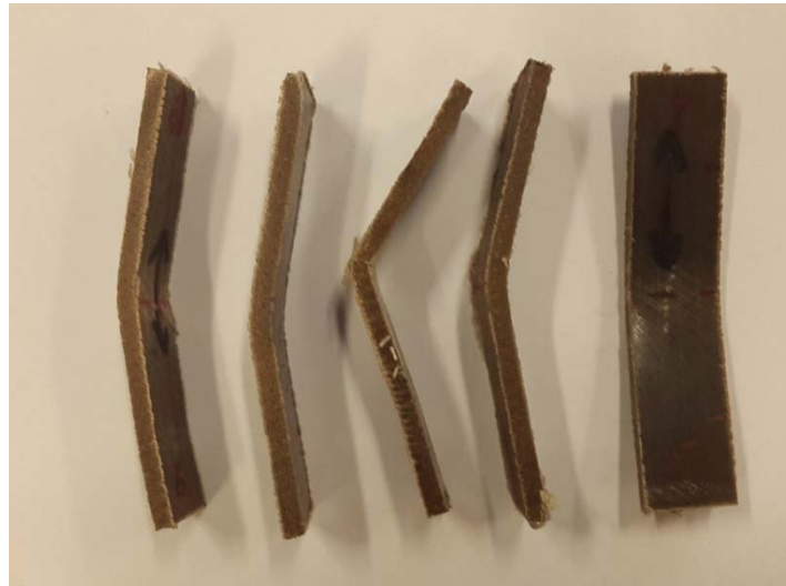
Figura 216. Imagen de las roturas obtenidas en las probetas de composite lino biaxial una vez finalizado el ensayo de flexión.
