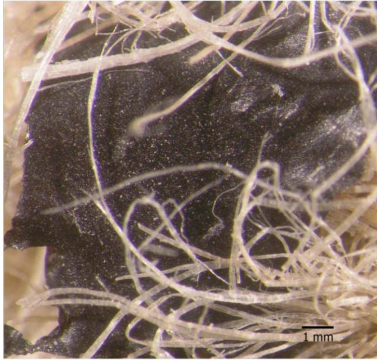
Figura 141. Imagen tomada en microscopio óptico x 0,8 aumentos de la fibra de cáñamo.
