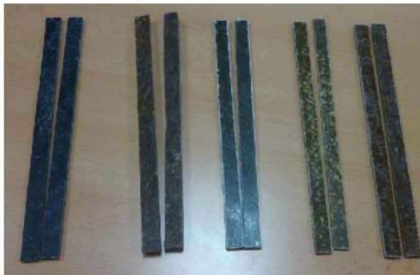
Figura 164. Imagen de las probetas utilizadas para la realización de los ensayos dinámicos de biocomposites.
