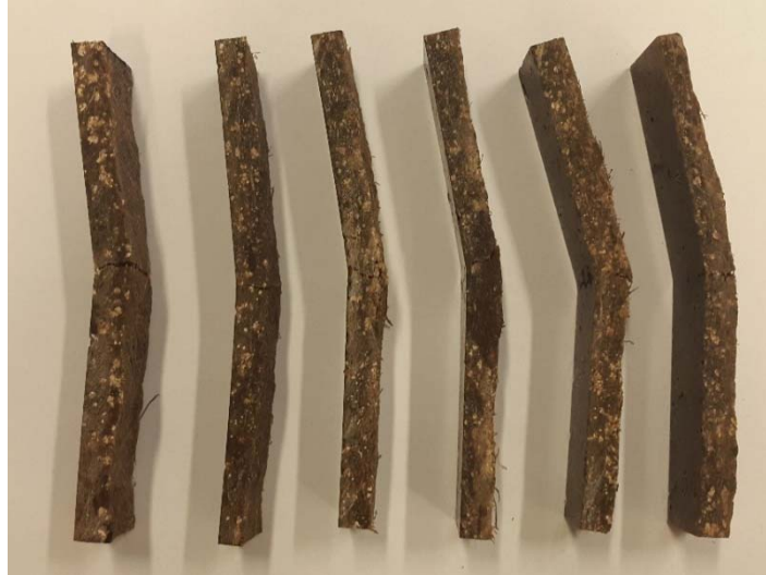
Figura 226. Imagen de las roturas obtenidas en las probetas del “green composite” de coco una vez finalizado el ensayo de flexión.
