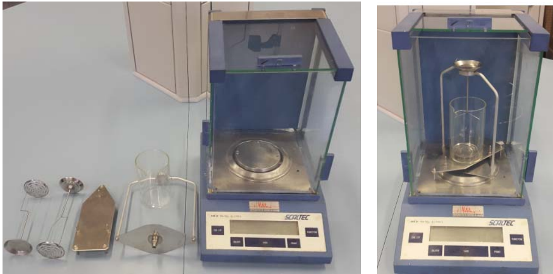
Figura 112. Imágenes de la balanza hidrostática y componentes auxiliares.
