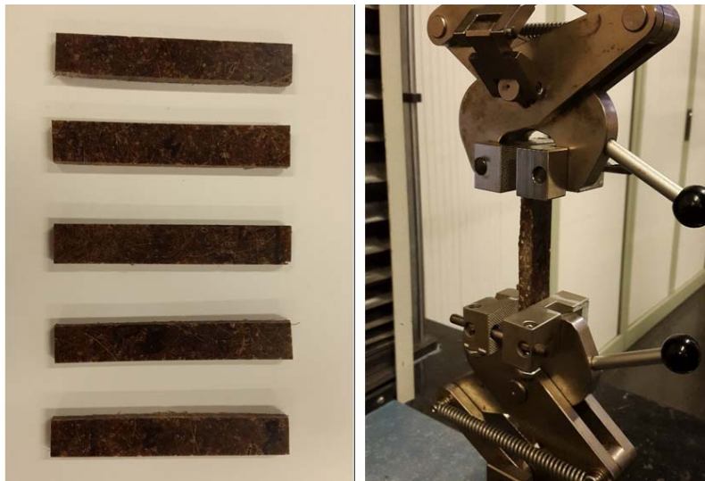
Figura 223. Imagen de las probetas de composite de coco y de su colocación en las mordazas de la máquina de tracción.
