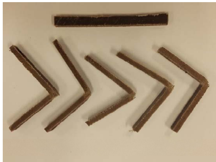
Figura 217. Imagen de las roturas en las probetas del composite lino biaxial una vez finalizado el ensayo de impacto.
