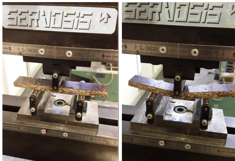
Figura 225. Imagen de la colocación de la probeta de “green composite” de coco en el útil de flexión en la máquina de tracción y su posterior rotura una vez finalizado el ensayo.
