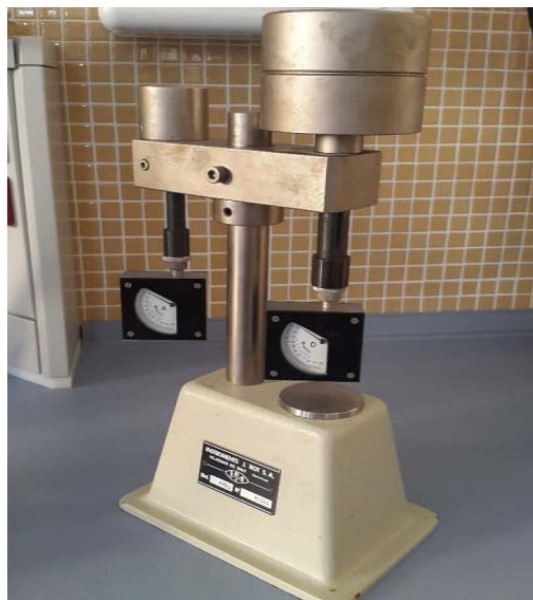
Figura 125. Imagen del durómetro Shore utilizado en el ensayo de dureza.
