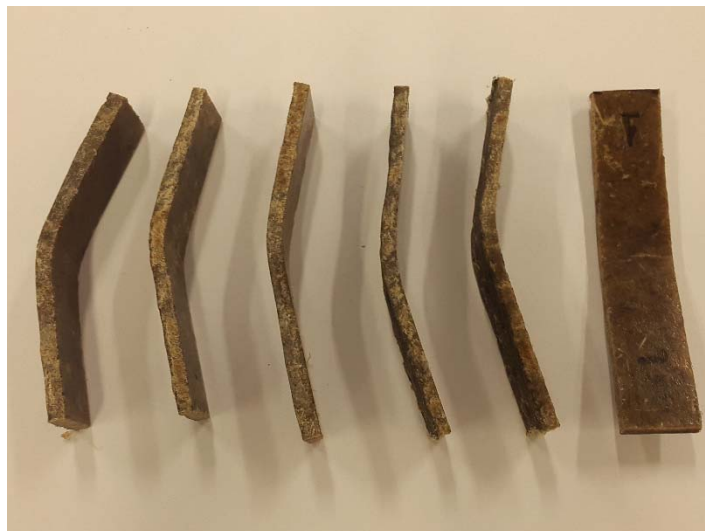
Figura 231. Imagen de las roturas obtenidas en las probetas del “green composite” de cáñamo una vez finalizado el ensayo de flexión.
