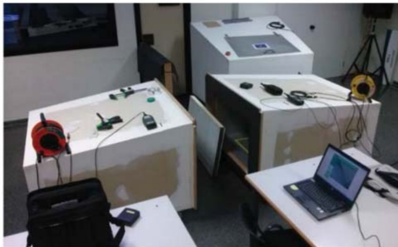
Figura 132. Captura de imagen durante la puesta en marcha del ensayo de aislamiento acústico al ruido aéreo en la cámara de transmisión de tamaño reducido.
