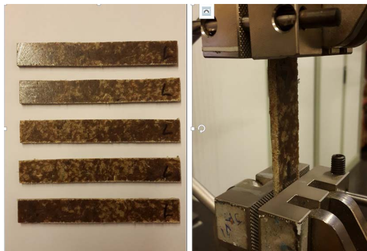
Figura 228. Imagen de las probetas del “green composite” cáñamo y de su colocación en las mordazas de la máquina de tracción.
