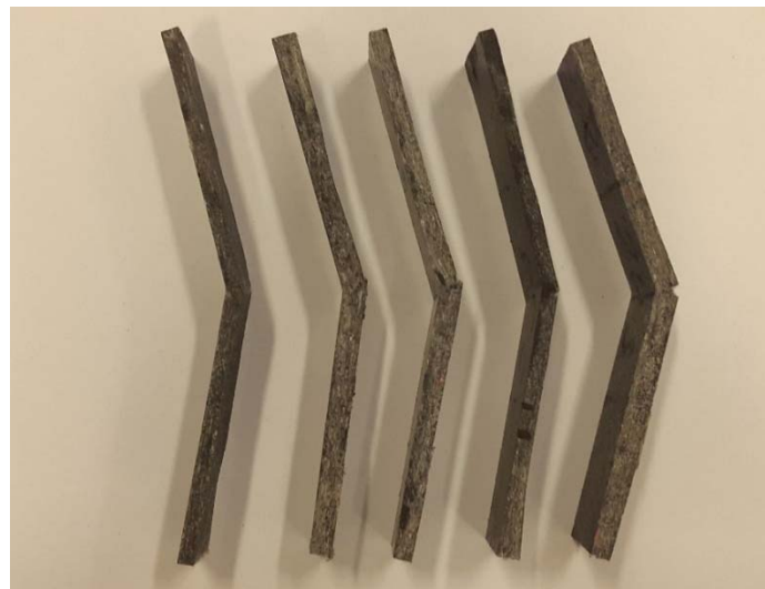
Figura 221. Imagen de las roturas obtenidas en las probetas del composite de Materia Textil Borra con bioresina una vez finalizado el ensayo de flexión.
