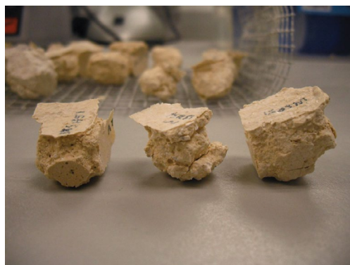
Fig 5.31 Baño de solución salina con las probetas. Fig 5.32 Estado de desintegración de tres probetas en el ciclo n°11.
