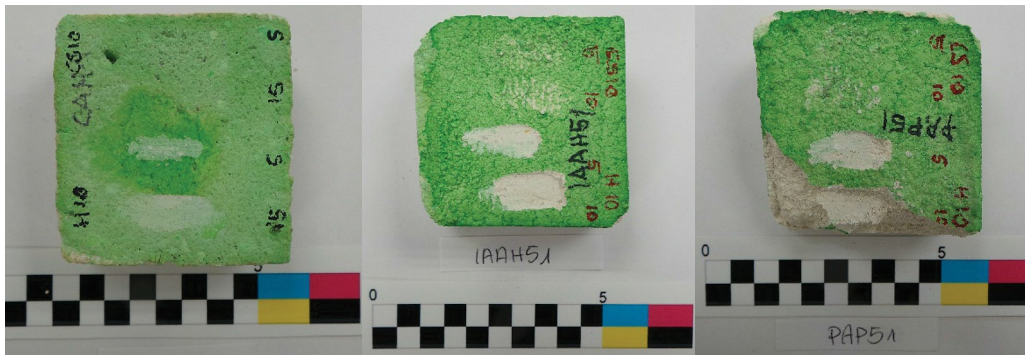
Figura 5.26 Nivel de desgaste superficial 1° y 2° (izquierda); profundo 1° y 2° (central) y profundo 2° y 3° (derecha).
