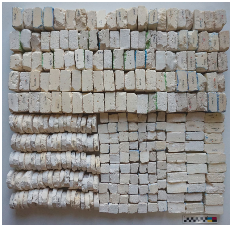
Fig. 5.15 Morfología de las probetas empleadas para los distintos ensayos de laboratorio.
