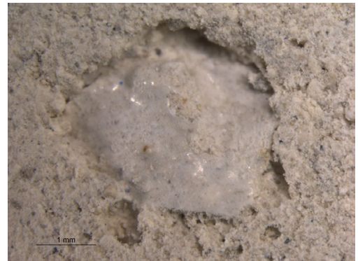
Fig. 5.44 Detalle de caliche en la probeta HAR2 antes y después del ensayo cíclico. No se aprecian cambios en la superficie.
