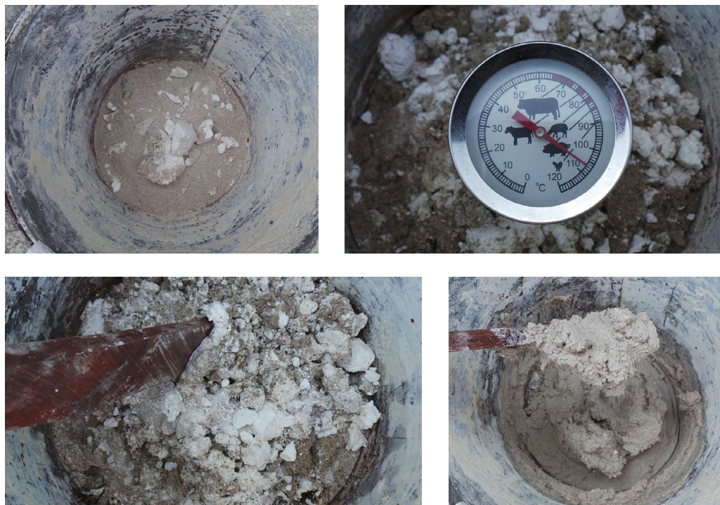
Fig. 5.7 Secuencia de apagado de la cal por mezclado en caliente (Hot Mix). Superior. Izda. Mezclado en seco del árido con la cal viva. Superior. Dcha. Adición de agua de macerado y reposo hasta alcanzar la máxima temperatura. Inferior. Izda. Adición de agua de macerado y mezclado. Inferior. Dcha. Mortero listo.
