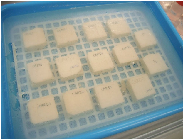
Figura 5.18 Ensayo de absorción de agua a presión atmosférica, grupo técnico IMA.
