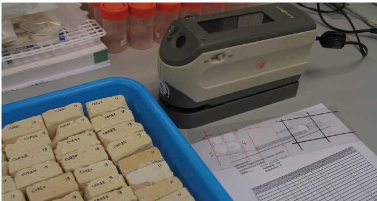
Fig. 5.34 Espectrofotómetro Minolta CM 2600d, plantillas de acetato y fichas de registro empleadas en la toma de datos.
