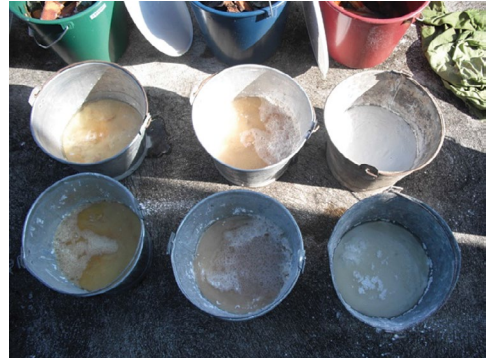
Fig. 5.3 y Fig. 5.4 Apagado de la cal viva en el agua de maceración, donde se observa la reacción exotérmica producida.
