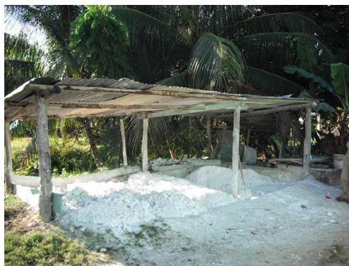
Fig. 5.1 Horno de cal de San Benito, Petén. Extracción de la piedra calcinada tras la cocción. Fig. 5.2 Calera de San Benito, Petén. Exposición de la cal viva para su apagado por pudrición.
