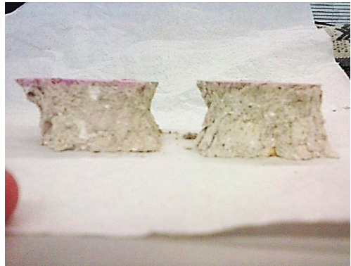
Fig. 5.29 Imagen del gráfico fuerza-tiempo donde se indica la fuerza máxima soportada (N), el tiempo transcurrido hasta el fallo (s), carrera (mm) y resistencia (Mpa). Fig. 5.30 Roturas producidas en dos probetas del grupo HA tras el ensayo.
