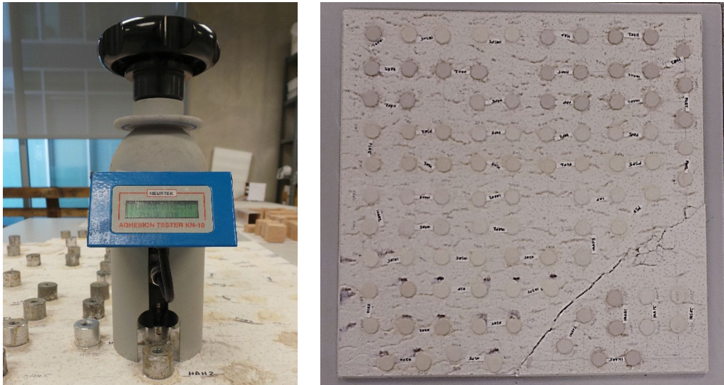
Fig. 5.27 Proceso de tracción directa sobre las probetas de mortero y total de probetas sometidas a ensayo.
