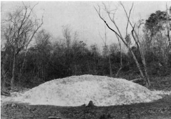
Fig. 3.11 Cal viva resultante de la calcinación de la piedra caliza, expuesta a la intemperie para su apagado. Fuente Morris et.al 1931.
