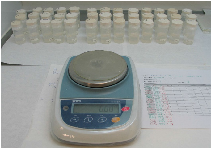
Figura 5.19 Ensayo de permeabilidad al vapor de agua durante la medición de la variación de la masa ( m_t ).
