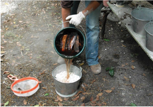
Fig. 5.3 y Fig. 5.4 Apagado de la cal viva en el agua de maceración, donde se observa la reacción exotérmica producida.
