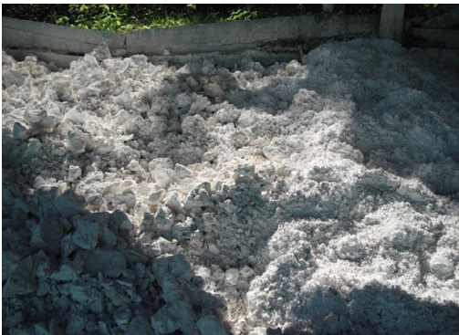
Fig.5.5 y Fig. 5.6 Apagado de la cal viva por exposición atmosférica (pudrición).
