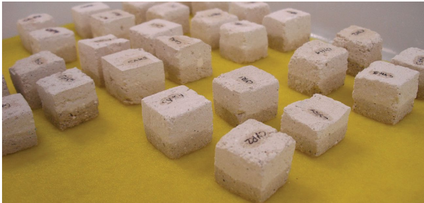
Figura 5.17 Absorción de agua por capilaridad de las probetas durante los primeros instantes del ensayo.
