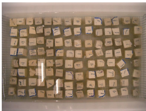
Fig 5.31 Baño de solución salina con las probetas. Fig 5.32 Estado de desintegración de tres probetas en el ciclo n°11.
