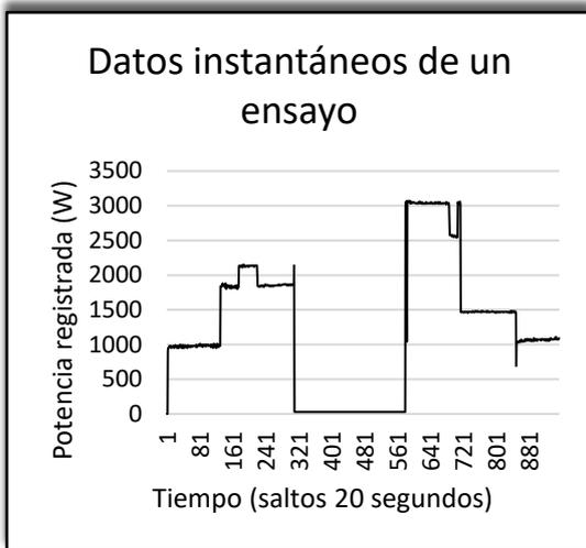
Ilustración 19. Forma de los datos instantáneos recogidos con LabVIEW.
