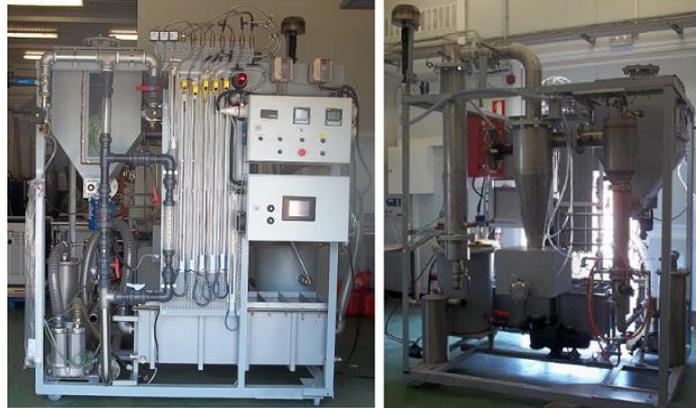
*Ilustración 2. Planta de gasificación de lecho fijo Down draft situada en el interior del LabDER*
