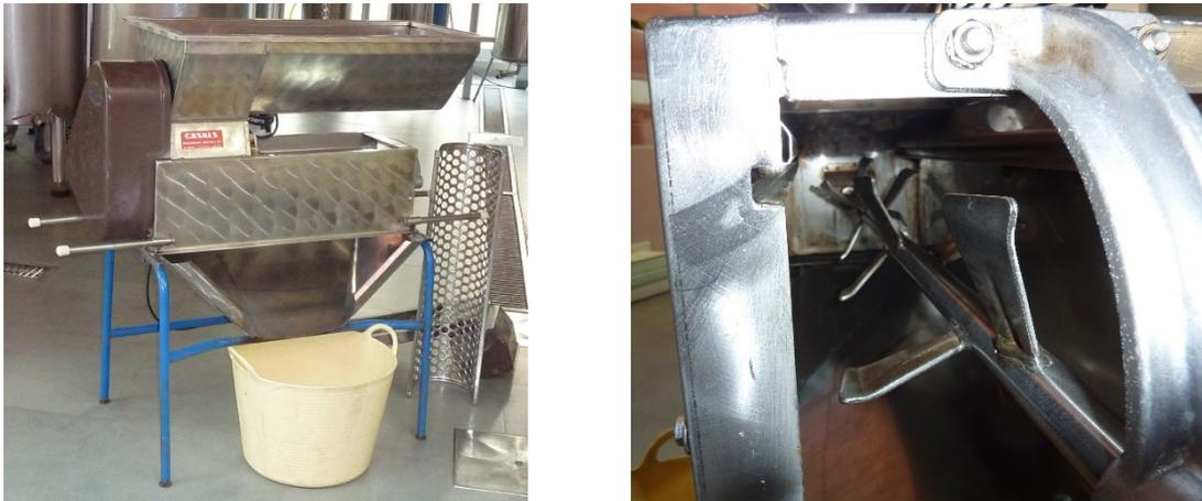
*Imagen 6: Detalles de la despalilladora-estrujadora*
