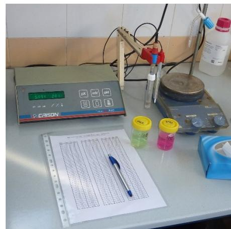
Imagen 5: Potenciómetro, agitador magnético y bureta
