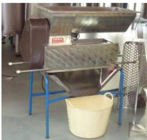
Figura 4. Despalilladora/Estrujadora.
