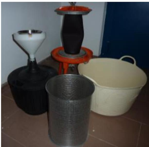
Figura 5. Prensa vertical de membrana.
