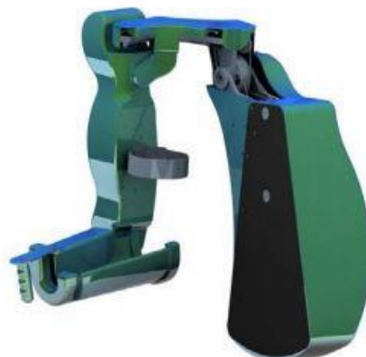
Figura 5. Exoesqueleto ABLE de miembro superior [14].
