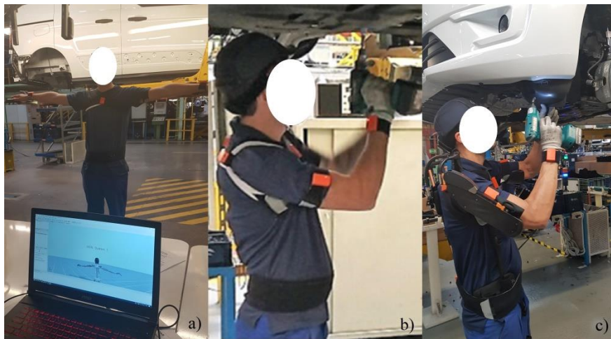
Figura 12. a) Calibración del sujeto; b) atornillado sin exoesqueleto; c) atornillado con exoesqueleto.
