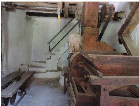
Figura 4.36 - Maquinària de preparació de la mòlta i serra de taula.
