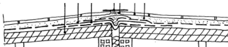
**Ilustración 28. Junta de dilatación de cubierta enrasada**
