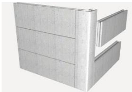
*Ilustración 25.Detalle constructivo del cerramiento lateral*
