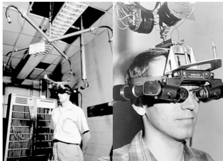
Fotografía 3. Imágenes del visor de Realidad Virtual conocido como La Espada de Damocles. (1968).
