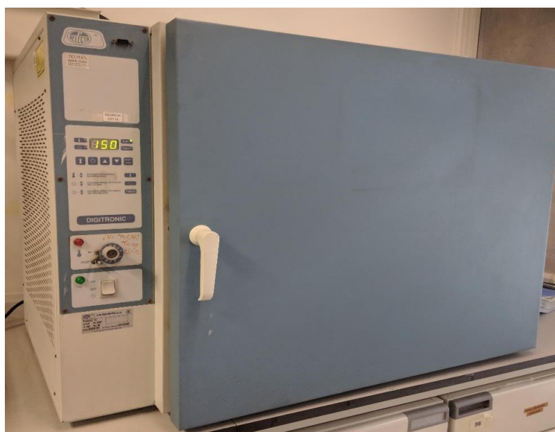
Figura 14. Estufa empleada para el curado de las muestras, JP Selecta 2005161.
