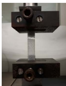
Figura 9. Fotografía de una de las probetas de espesor 2,1 mm fracturada después de finalizar el ensayo de tracción y aún sujeta por las mordazas.
