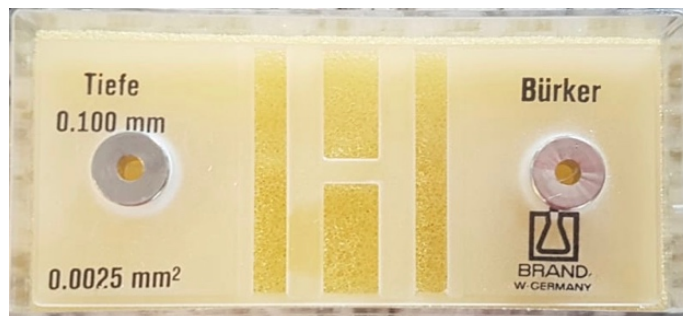
Figura 5. Cámara cuentaglobos para determinar la concentración espermática.
