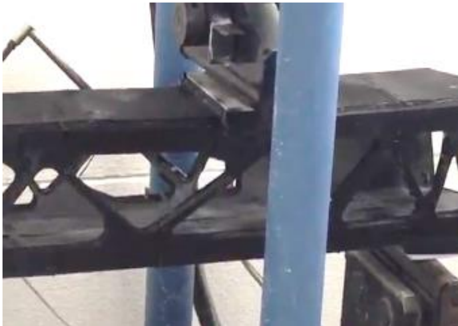
Figura 135. Carga excéntrica en ensayo a flexión en 3 puntos de la Estructura D – PLA + UHPC + ARMADURA CFRP. Fuente: Autor.
