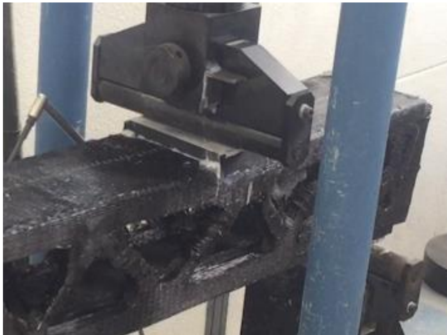
Figura 129. Detalle carga excéntrica en ensayo a flexión en 3 puntos de Estructura B – PLA + CFRP. Fuente: Autor.
