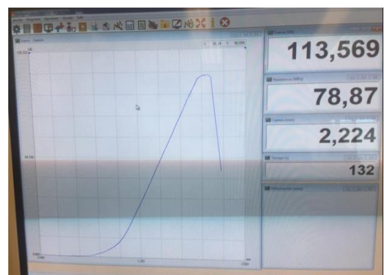
Figura 111. Resultados del ensayo a compresión de la Probeta 4 - C (40x36 mm). Fuente: Autor.
