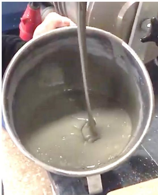
Figura 13. UHPC-Microhormigón amasado en Laboratorio de materiales ETSIE-UPV.2019 Fuente: Autor.
