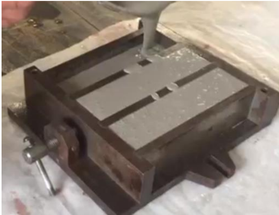
Figura 52. Vertido de Amasada M3 en molde. Fuente: Autor.
