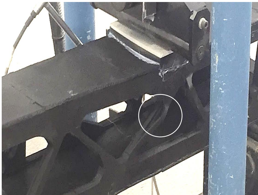
Figura 126. Rotura del ensayo a flexión en 3 puntos de la Estructura A – Sólo PLA. Fuente: Autor.
