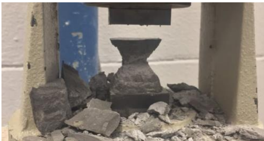
Figura 99. Probeta 4 - A (40x40 mm) tras ensayo a compresión. Fuente: Autor.
