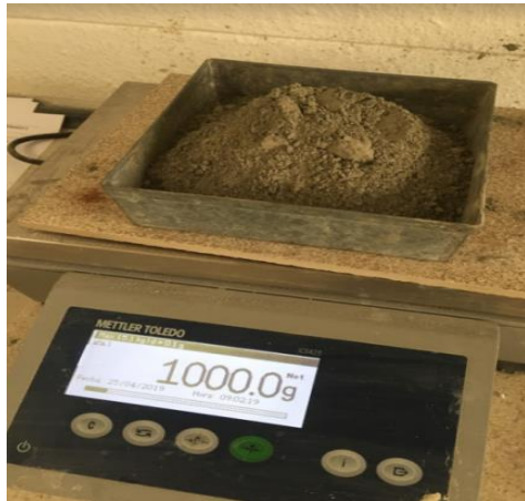
Figura 45. Peso de cemento CEM I - 52,5 R en báscula. Fuente: Autor.
