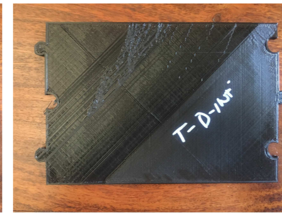
Pieza: S-D-TODO UHPC. Peso: 70g Tiempo de impresión: 3h 6"
