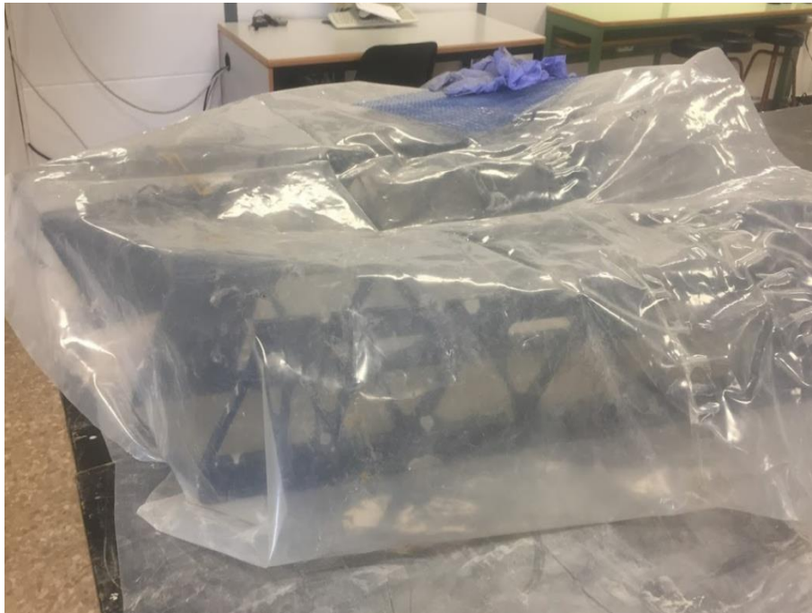
Figura 79. Proceso de curado del hormigón. Fuente: Autor.
