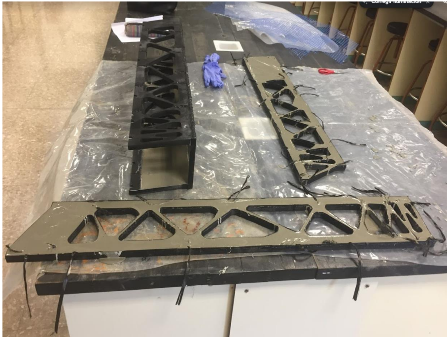
Figura 87. Fase de hormigonado de los dos Alzados A y B de la estructura. Fuente: Autor.
