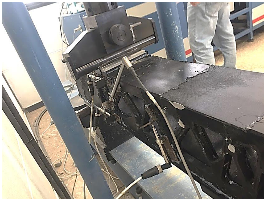
Figura 123. Captadores LVDT en barras de Estructura a ensayar. Fuente: Autor.
