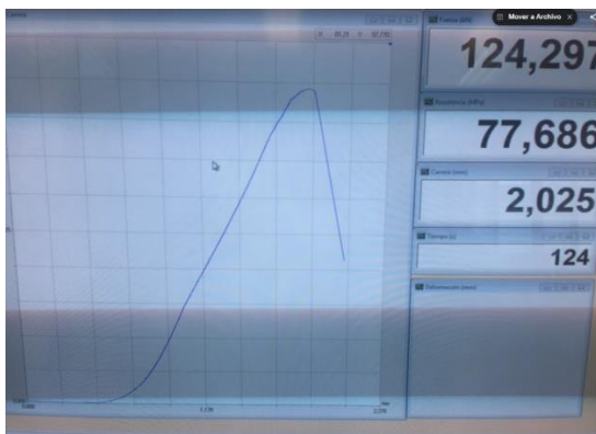
Figura 104. Resultados del ensayo a compresión de la Probeta 2 - B (40x40 mm). Fuente: Autor.
