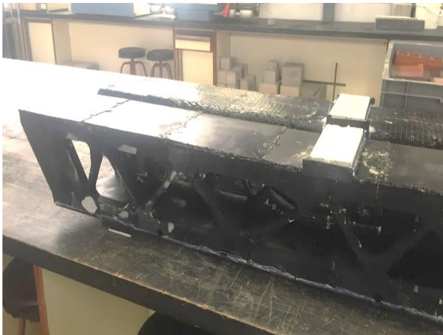
Figura 120. Apoyo superior para aplicar tensión de flecha en ensayo a flexión en tres puntos. Fuente: Autor.
