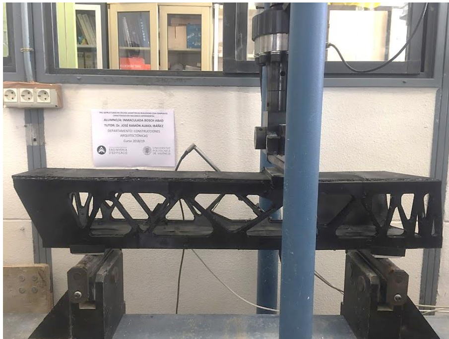
Figura 125. Ensayo a flexión en 3 puntos de la Estructura A – Sólo PLA. Fuente: Autor.
