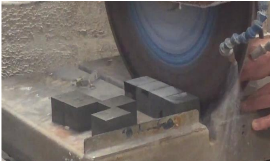
Figura 98. Corte de probetas en máquina de chorro de agua, previa medición. Fuente: Autor.
