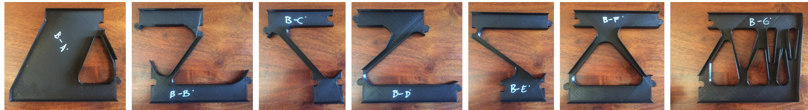
Pieza: B-G-TODO UHPC. Peso: 81 g Tiempo de impresión: 4h 5"
