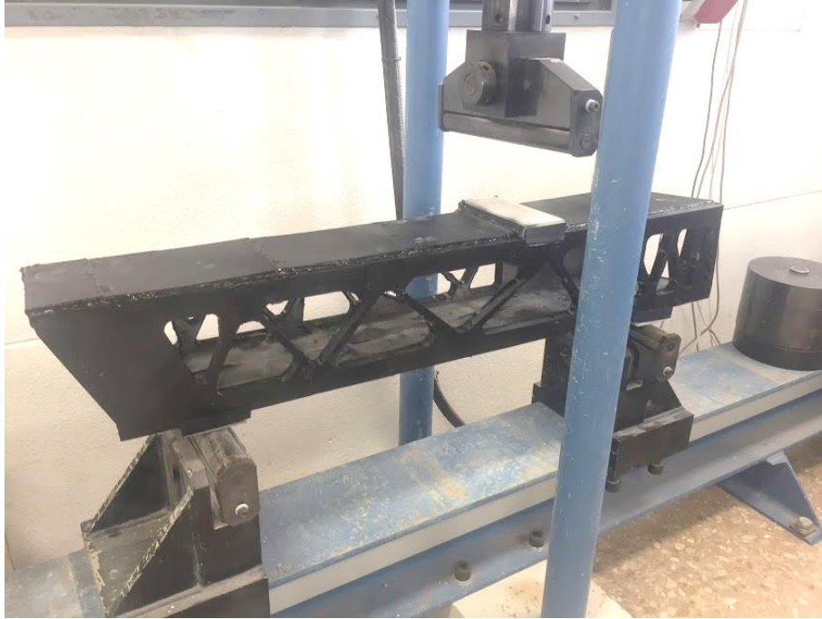
Figura 134. Ensayo a flexión en 3 puntos de la Estructura D – PLA + UHPC + ARMADURA CFRP. Fuente: Autor.
