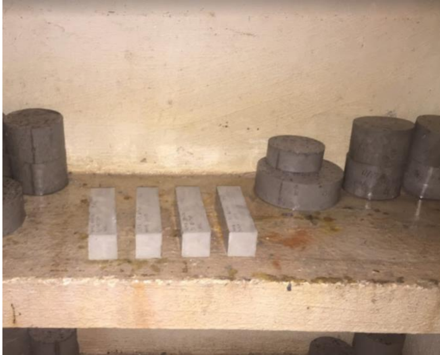
Figura 54. Probetas en cámara húmeda durante 7 días. Fuente: Autor.
