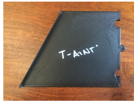
Pieza: S-A-TODO UHPC. Peso: 51 g Tiempo de impresión: 2h 17"
