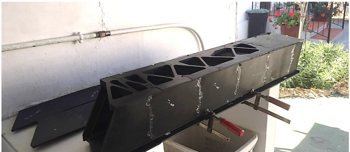
Figura 60. Proceso de unión piezas de estructura genérica simple. Fuente: Autor.
