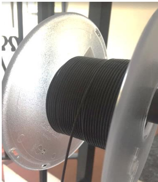
Figura 17. Bobina de filamento PLA (ácido poliláctico) de 1,75 mm de diámetro. 2019 Fuente: Autor.
