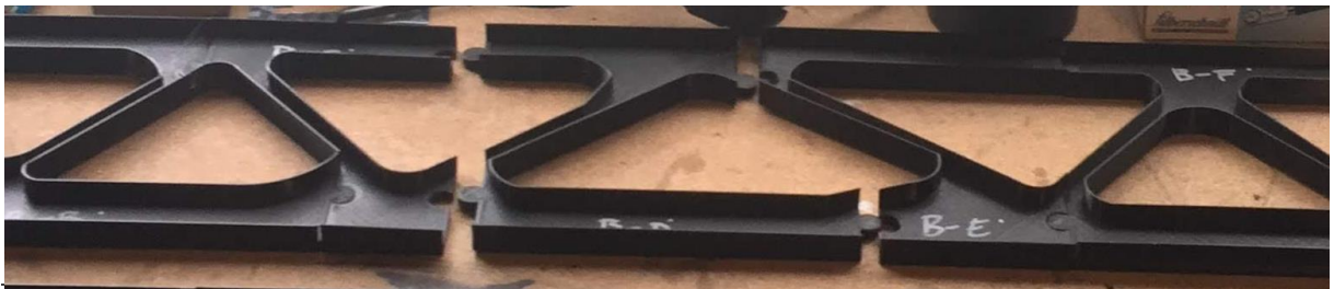
Figura 29. Enlace entre piezas impresas con metodología 3d. 2019 Fuente: Autor.
