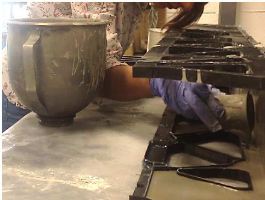
Figura 78. Hormigonado Alzado B. Fuente: Autor.
