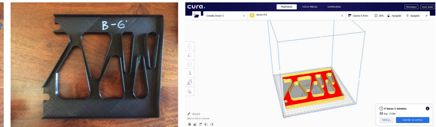
Pieza: B-G-TODO UHPC. Peso: 81 g Tiempo de impresión: 4h 5"
