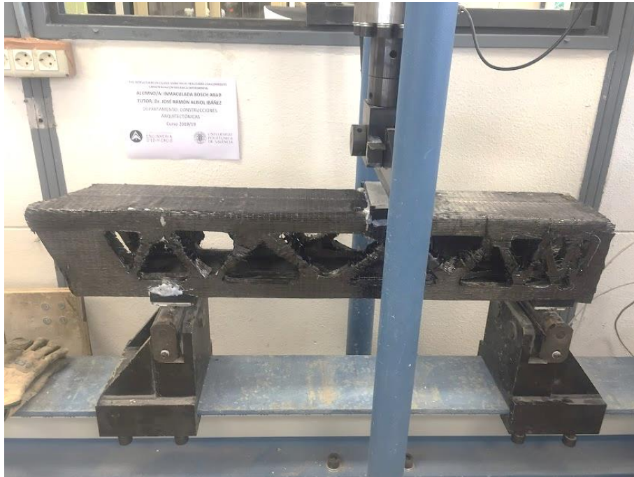
Figura 128. Ensayo a flexión en 3 puntos de Estructura B – PLA + CFRP. Fuente: Autor.
