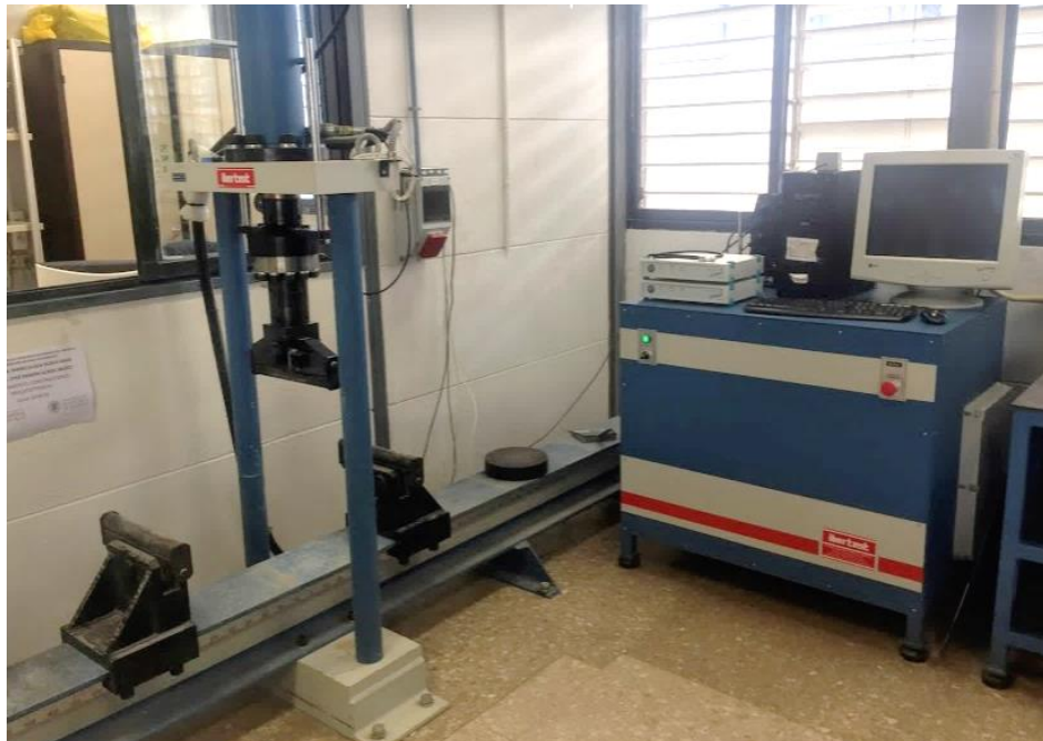
Figura 121. Equipo IBERTEST de ensayo a flexión en tres puntos. Fuente: Autor.
