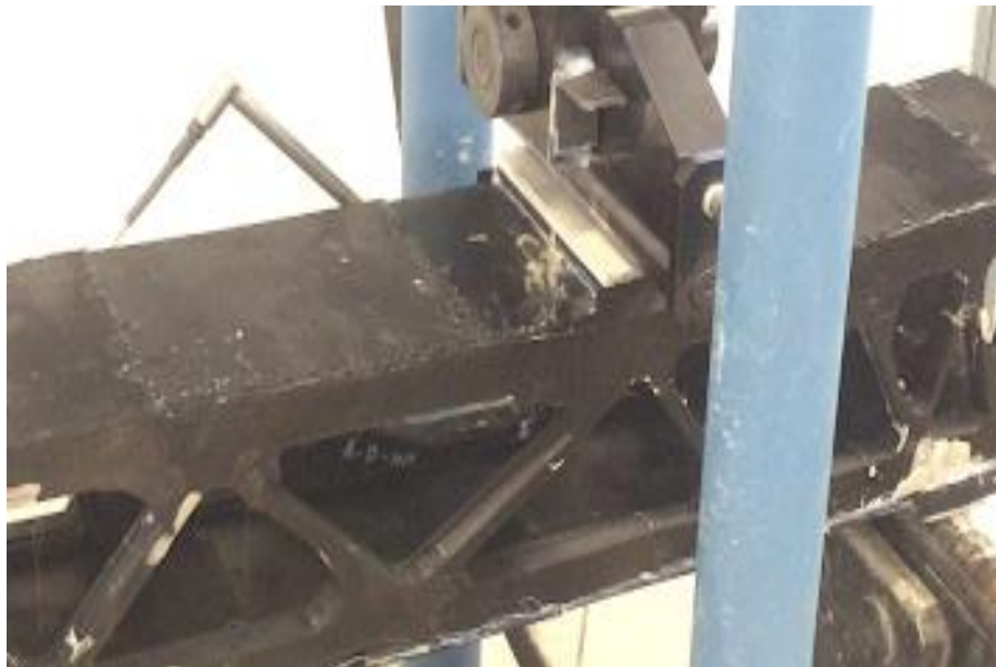
Figura 132. Detalle de carga excéntrica del ensayo a flexión en 3 puntos de la Estructura C – PLA + UHPC en barras. Fuente: Autor.
