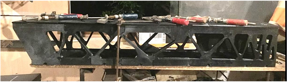
Figura 61. Estructura genérica simple en proceso de secado de la resina epoxi para las uniones. Fuente: Autor.
