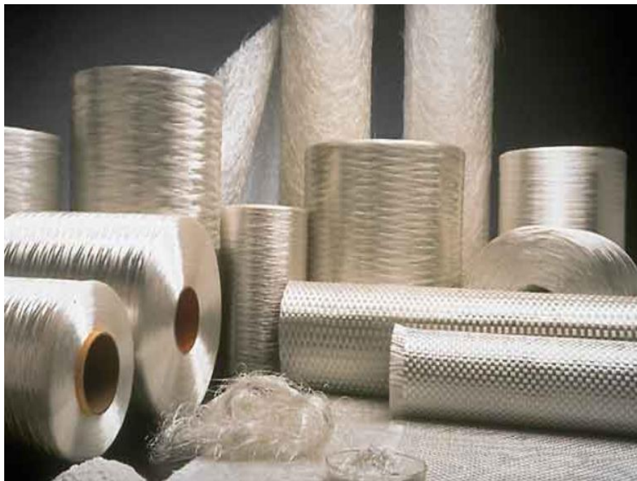
Figura 12. Diferentes formas de encontrar la fibra de vidrio - GFRP. 2011 Fuente: Tecnología de los plásticos.
