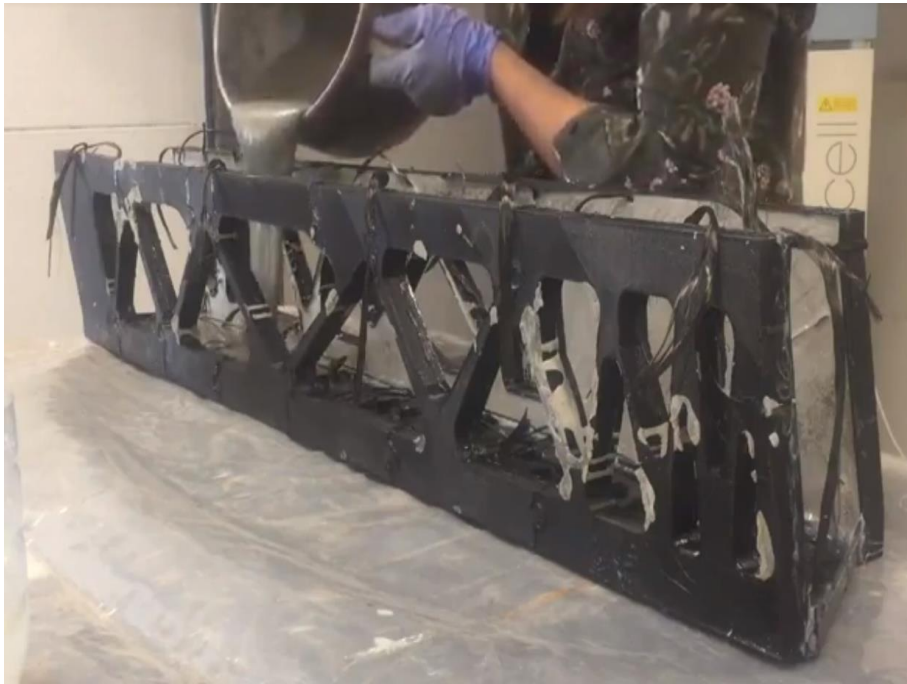
Figura 91. Hormigonado de forjado inferior con microhormigón-UHPC. Fuente: Autor.
