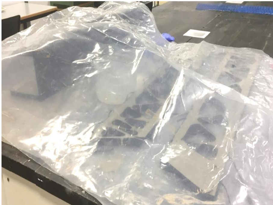
Figura 88. Fase de curado del microhormigón-UHPC vertido en los dos Alzados A y B de la estructura. Fuente: Autor.
