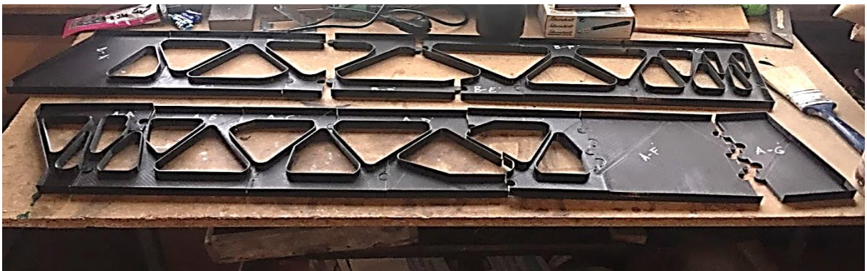
Figura 59. Proceso de unión de los alzados A y B. Fuente: Autor.
