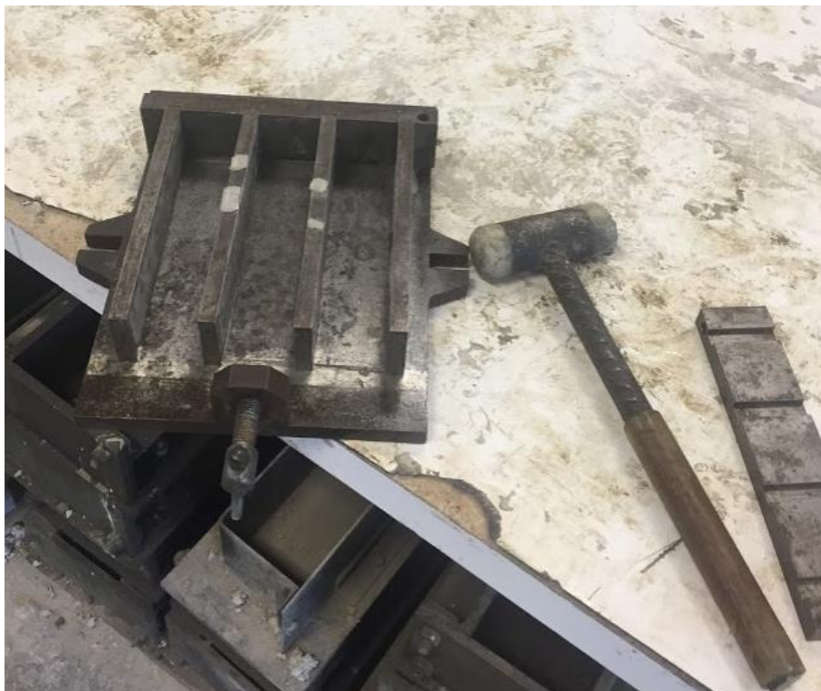
Figura 53. Desmolde de probetas de Amasada M3. Fuente: Autor.
