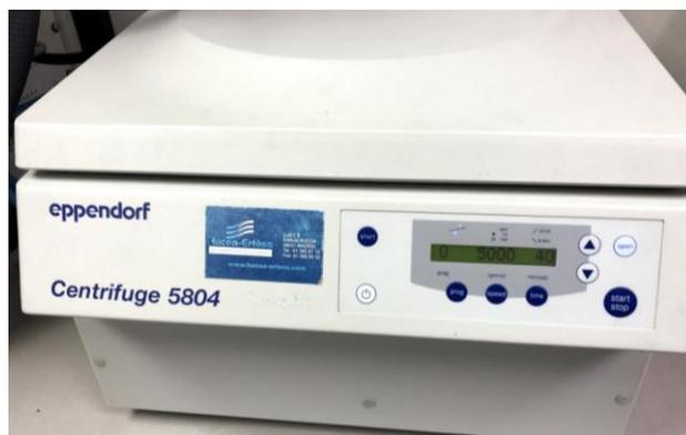
Figura 5. 4. Centrifuga con las revoluciones y los minutos para un lavado de las partículas.
