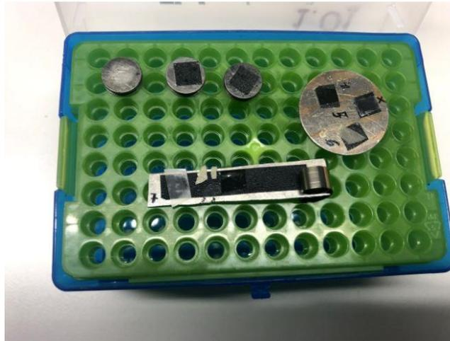
Figura 5. 14. Muestras preparadas para el equipo FE-SEM.
