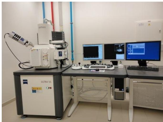
Figura 5. 13. Equipo FE-SEM instalado en el Servicio de Microscopía de la UPV.
