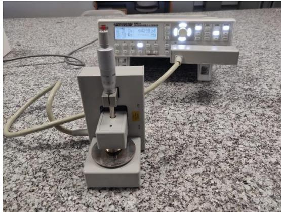
Figura 5. 15. Dispositivo de prueba para material dieléctrico del departamento de Ingeniería Mecánica y de Materiales de la UPV.
