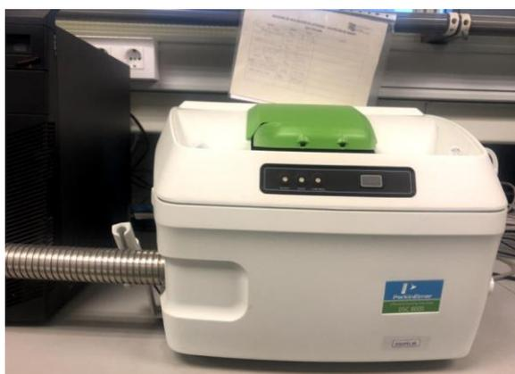
Figura 5. 11. Equipo de calorimetría diferencial de barrido (DSC) del CBIT.
