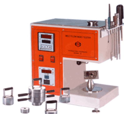
Figura 2.12. Equipo empleado para realizar el ensayo de medida del índice de fluidez de masa fundida
