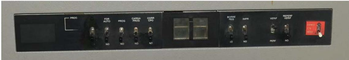
Figura 3.25: Detalle de los controles de verificación y corrección de la IBM 5496. Museo de Informática
