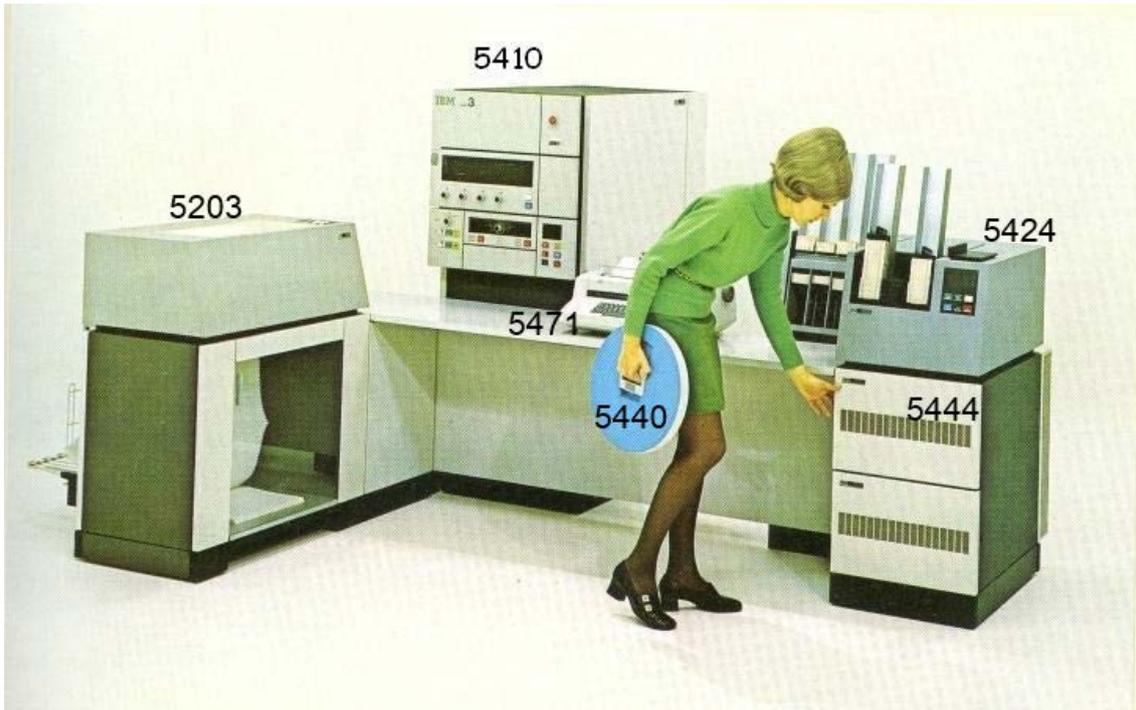
**Figura 2.12:** En la figura se observa como la operadora se dispone a insertar una unidad extraíble IBM 5440 en la unidad de almacenamiento IBM 5444. El modelo original (Modelo 10) no disponía de esta unidad
