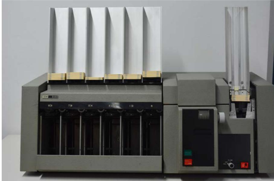
**Figura 4.25:** La clasificadora IBM 5486 se podía utilizar sin las complicaciones que acarrearía la necesidad de preparar un programa como era el caso de la MFCU, sin embargo, era necesario dar instrucciones exactas al operador. Museo de Informática
