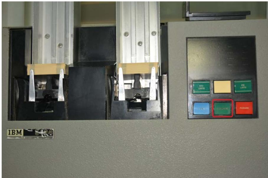
**Figura 4.13:** Pulsando el botón de arranque, (remarcado en rojo), se pone en marcha la MFCU
