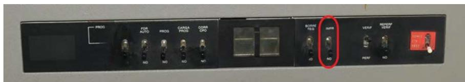
**Figura 4.36:** Si el interruptor de impresión (remarcado en rojo) de la grabadora de datos IBM 5496 estuviese en la posición ON, los datos registrados en la tarjeta se interpretarán en la parte superior de la misma. Es así como dicha tarjeta se hace legible, tanto para las personas como para la máquina
