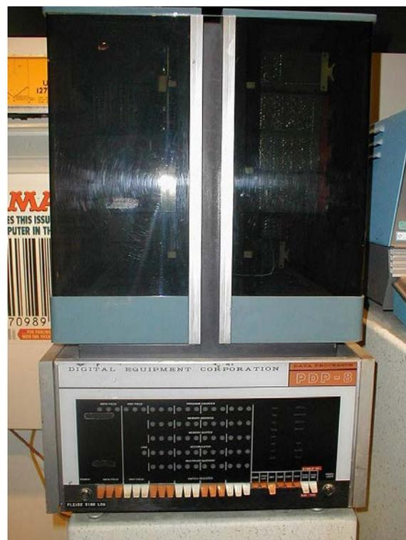
Figura 2.3: Una PDP-8 de muestra en el Museo Nacional de Historia Americana del Instituto Smithsonian en Washington, D.C. Este es un ejemplo de la primera generación de PDP-8, construida con transistores discretos y más tarde conocida como Straight 8
