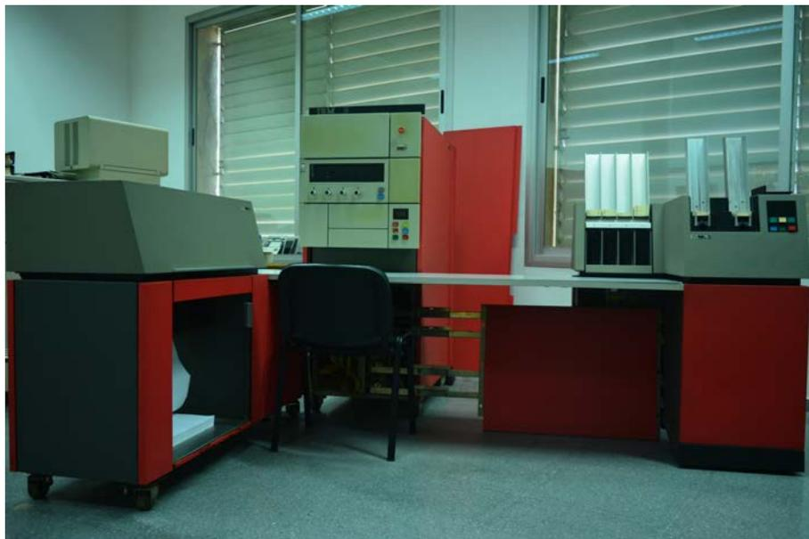
**Figura 2.22:** El IBM System/3 del Museo de Informática. De izquierda a derecha tenemos la impresora 5203, la CPU 5410 y la MFCU 5424
