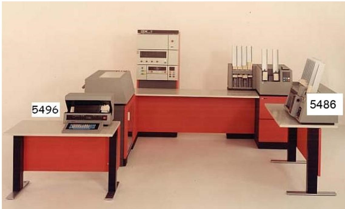
**Figura 2.14:** El grabador de datos IBM 5496 y la clasificadora IBM 5486 eran los dos dispositivos offline del System/3
