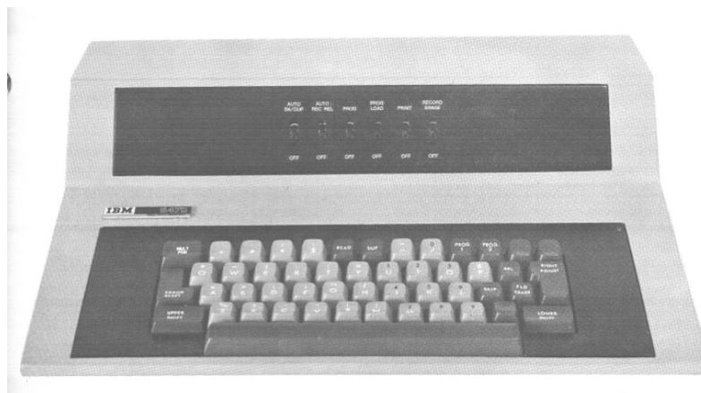
**Figura 2.13:** El teclado de entrada de datos (IBM 5475) graba y verifica datos en combinación con las capacidades de manejo de tarjetas de la MFCU
