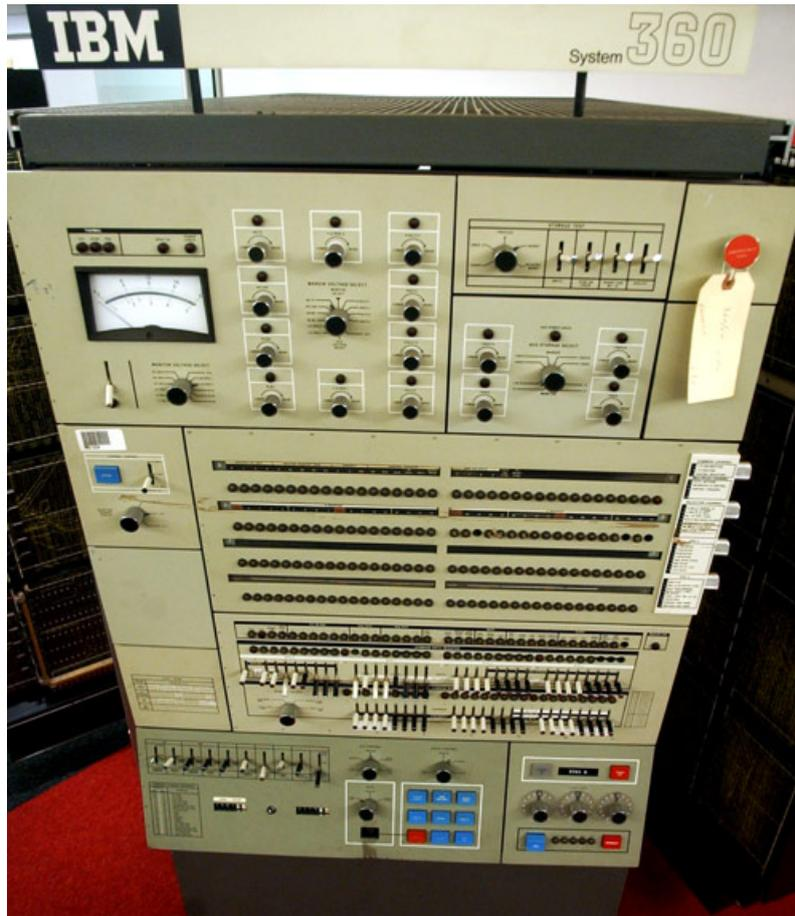
**Figura 2.1:** Consola del operador de un System/360 Modelo 65, con válvula de registro, lámparas y switches (mitad de la fotografía), y arriba a la derecha, un interruptor de emergencia rojo
