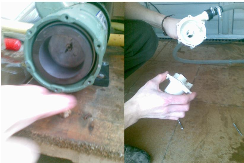
*Cuerpo de la bomba y rotor desmontado por una obstrucción*
