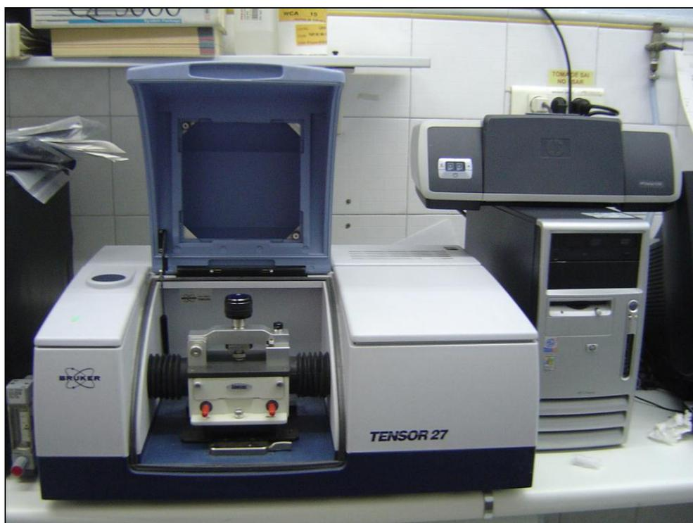
Foto de un espectrofotómetro infrarrojo de transformada de Fourier con accesorio para realizar los infrarrojos por la técnica de ATR (reflectancia total atenuada).
