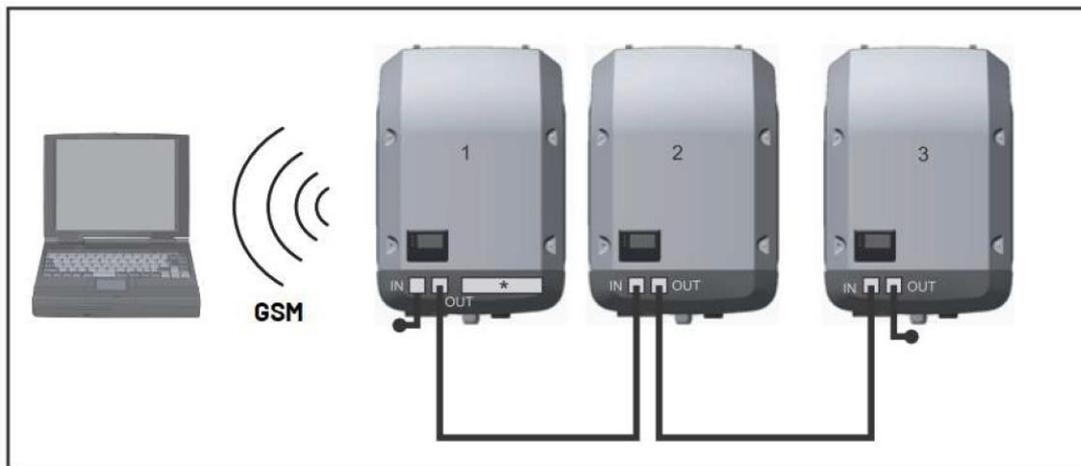
Imagen 19: Esquema de la conexión entre inversores.
