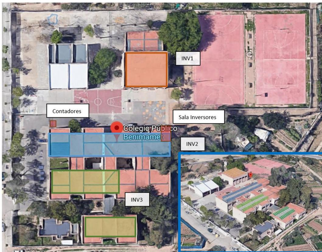
Imagen 4: Tres áreas diferenciadas regidas cada una por un inversor.
