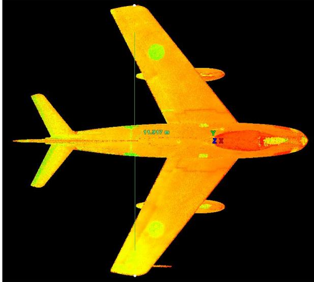
**Figura 4.55:** Medida de la envergadura del F-86F Sabre,  $b = 11,917m$
