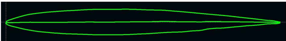
**Figura 7.21:** Perfil del estabilizador vertical importado al entorno del programa *XFLR5*
