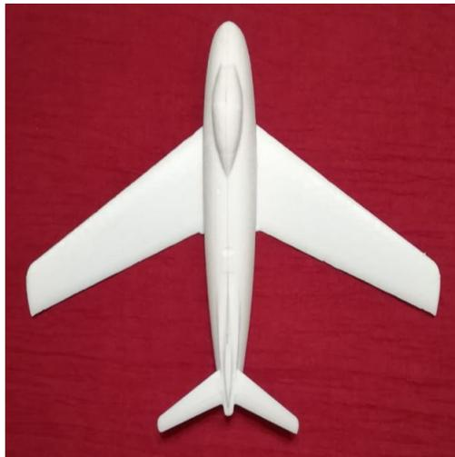
**Figura 6.5:** Modelo de la prueba de impresión del F-86F Sabre
