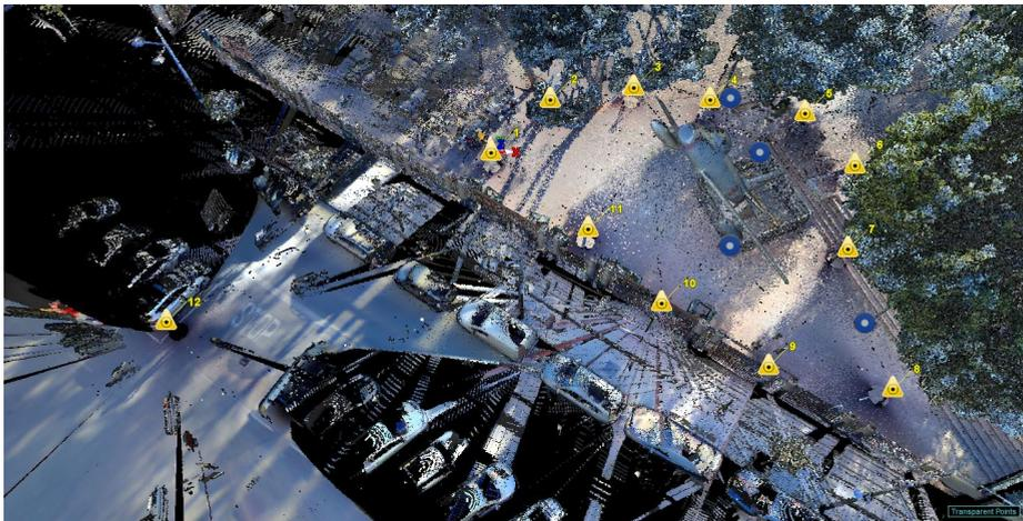
Figura 4.11: Esquema de la posición de los estacionamientos y las dianas
