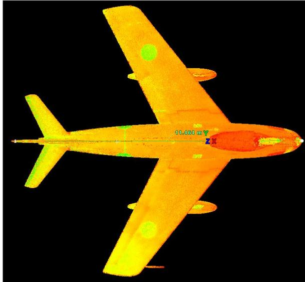
**Figura 4.56:** Medida de la longitud del F-86F Sabre,  $L = 11,464m$
