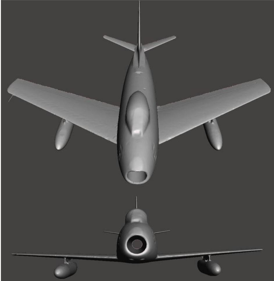
**Figura 5.31:** Malla final del F-86F Sabre con orificio para el paso del aire
