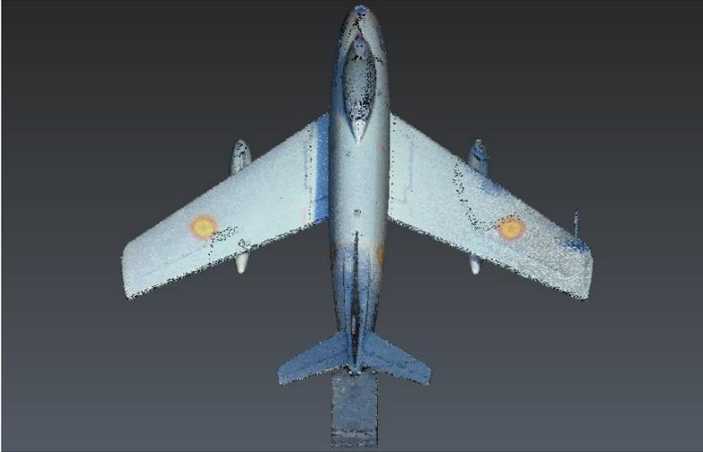
**Figura 5.24:** Nube de puntos del F-86F Sabre con el soporte en *3DReshaper*
