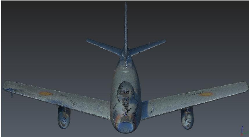
**Figura 5.1:** Nube de puntos del F-86F Sabre en *3DReshaper*
