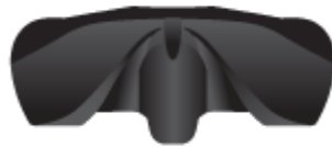
Figura 60: Casco de doble túnel
