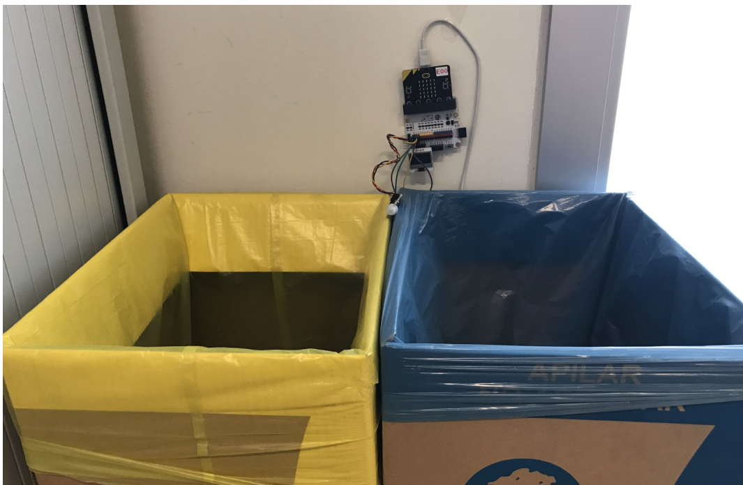
Figura 5.9: Tarjeta micro:bit receptora con sensor PIR.
