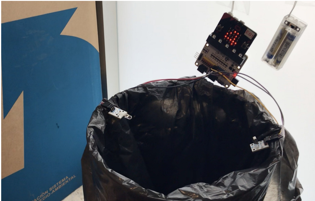
Figura 5.10: Tarjeta micro:bit emisora con sensores infrarrojos.
