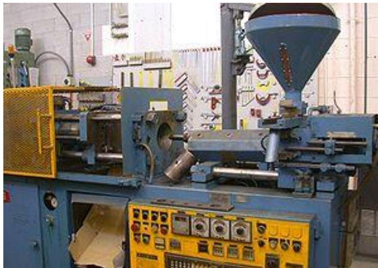
Figura 99. Máquina de inyección de plásticos
