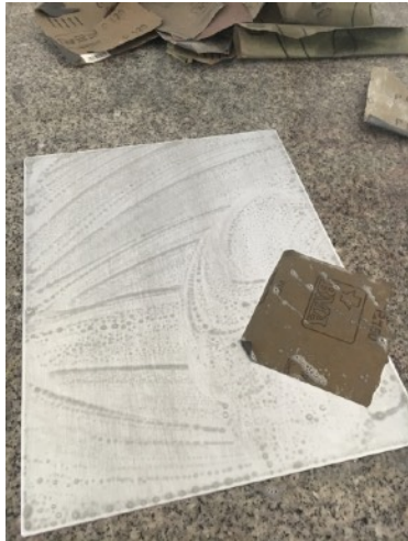
Figura 33. Lijado de la plancha.
