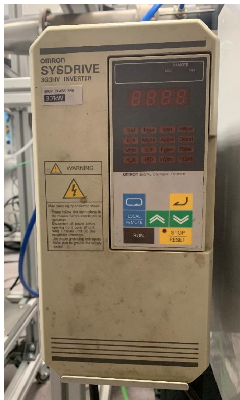
Figura 3.5. Variador de frecuencia
