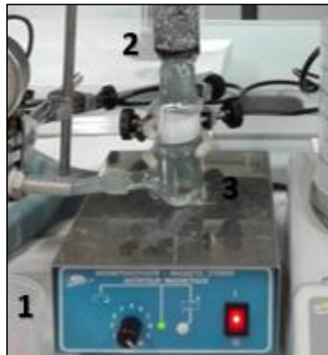
Figura 6. Detalle de la parte inferior de la columna de relleno. Agitador magnético (1), filtro de rejilla (2), imán (3).
