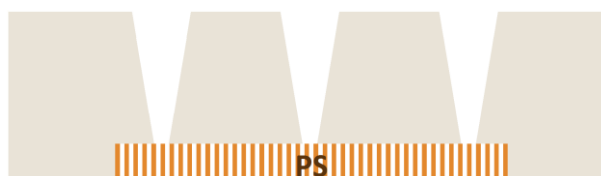
Figura 87. Ilustración de la anodización de un sustrato de silicio con regiones de espesor rebajado para la obtención de una estructura de PS.
