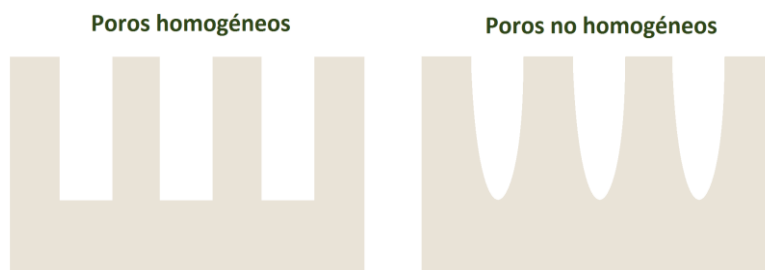
Figura 29. Comparación entre una estructura porosa con un diámetro constante y otra en la que el diámetro varía en función de la profundidad.
