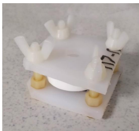
Figura 84. Ilustración de la celda utilizada para el ataque húmedo con KOH y fotografía de ella.
