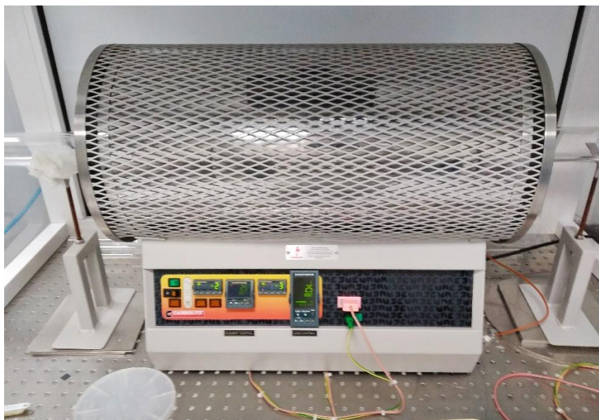
Figura 45. Horno CTF 12 utilizado en este trabajo para la oxidación de PS.
