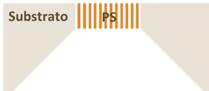
Figura 78. Membrana de PS obtenida tras la eliminación del substrato bajo la estructura porosa.
