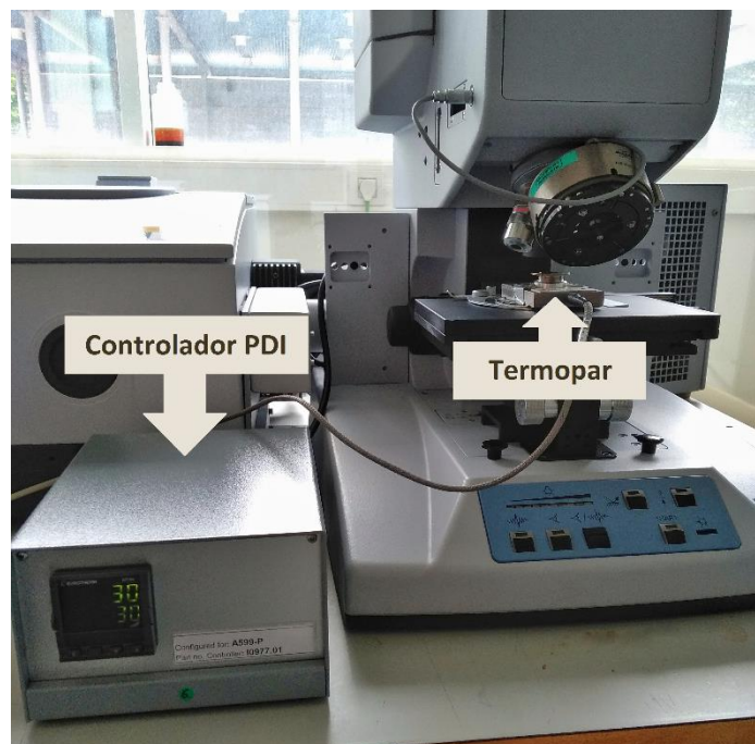
Figura 35. Fotografía del montaje experimental para la determinación del TOC en el PS.
