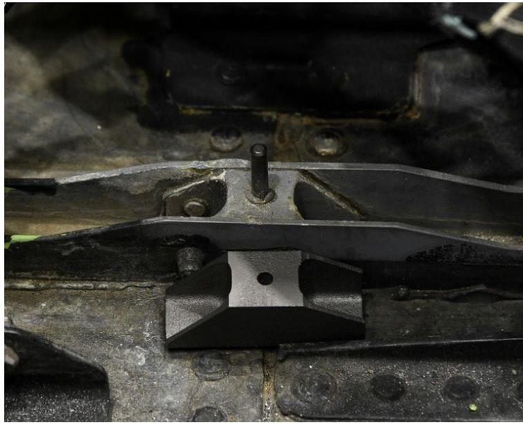
*Figura 3. Pieza de aluminio de un F22 propensa a la corrosión y su reemplazo impreso en titanio.*
