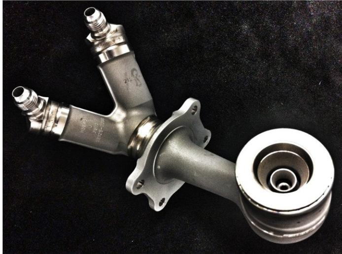
Figura 5. Inyector de combustible del motor turbofan LEAP. (fuente: CFM International).
