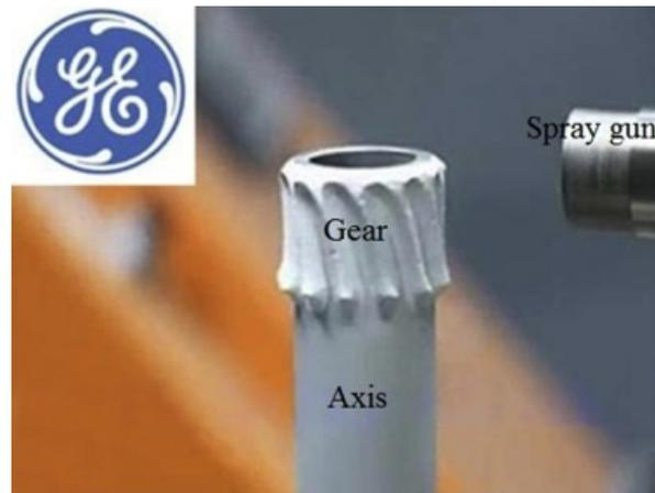
Figura 31. Creación de un engranaje por proyección en frío. (fuente: GE Additive)
