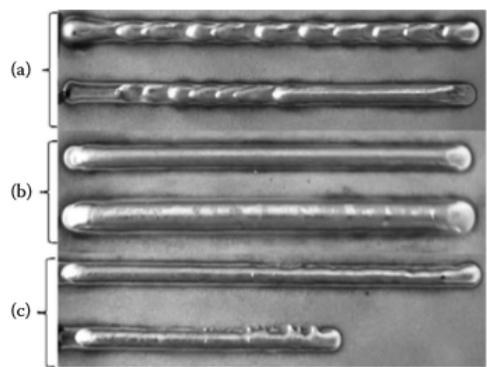
Figura 17. Depositiones de IN625. a) Goteo del hilo. b) Deposition suave. c) Colisión del hilo.
