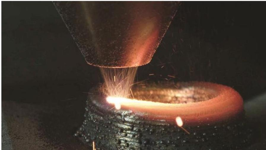
Figura 10. Pérdida de material y goteo en proceso LMPD.
