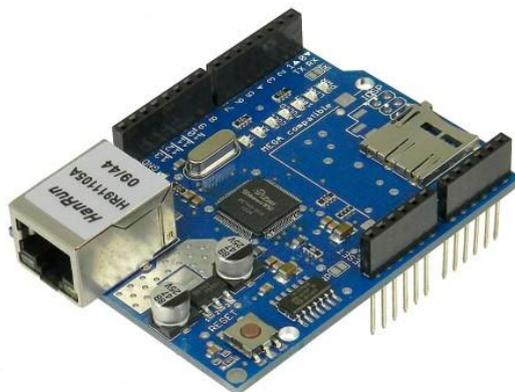
**Figura 10:** shield Ethernet con lector microSD. Fuente: <http://www.maxelectronica.cl/shield-Arduino/4-Arduino-shield-ethernet-w5100.html>
