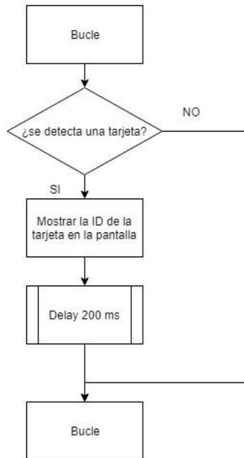
**Figura 24:** Diagrama de flujo de la detección de las tarjetas. Fuente: propia.
