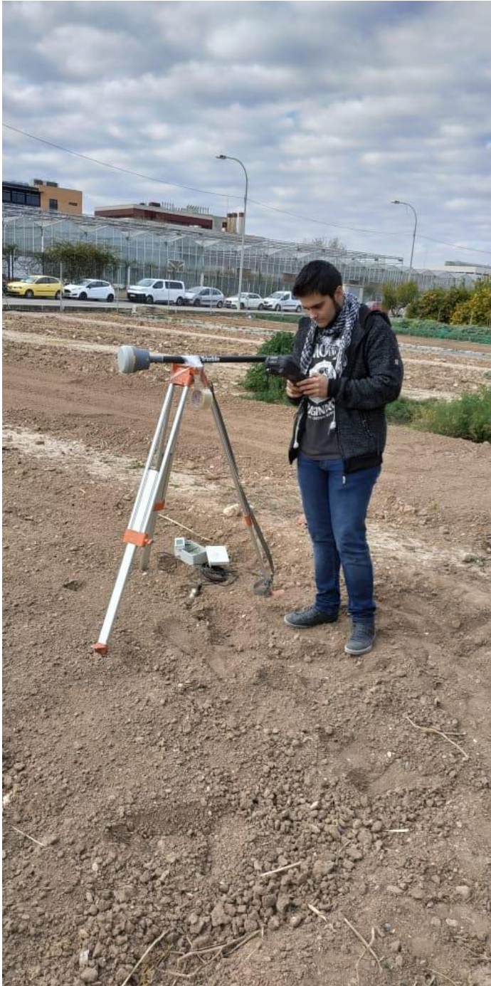
Ilustración 60, Estacionamiento del receptor R10 en horizontal tras unos días de lluvia en la parcela rústica
