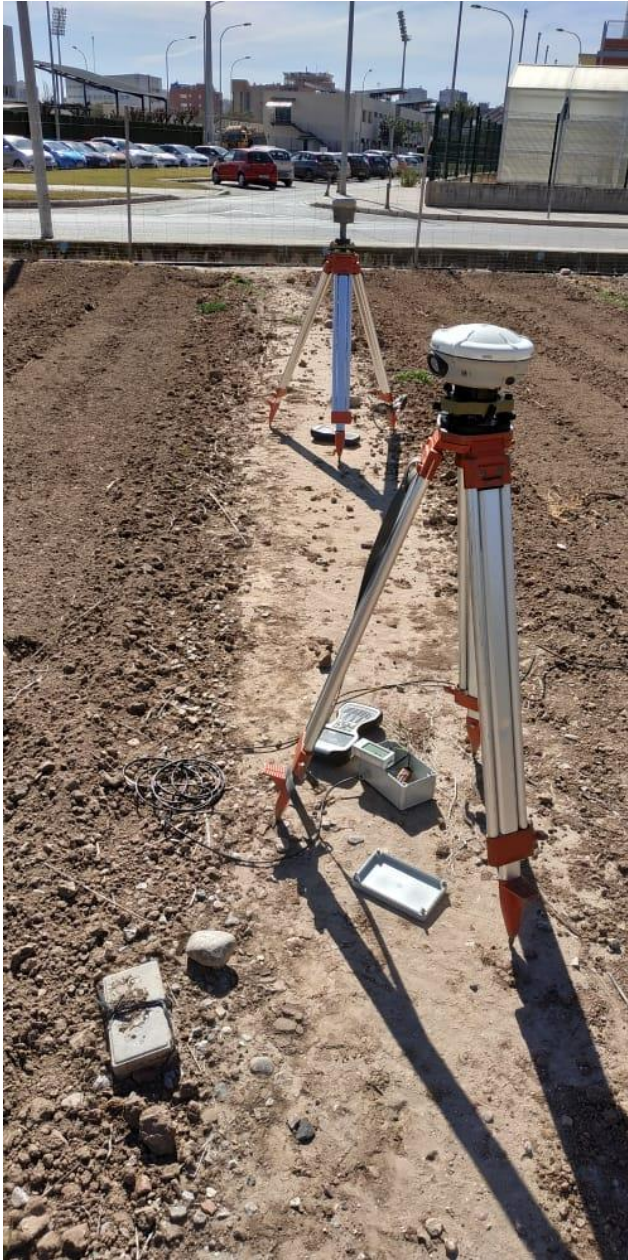
Ilustración 61, Toma de datos con receptores R8 y R10 en parcela cercana a la UPV
