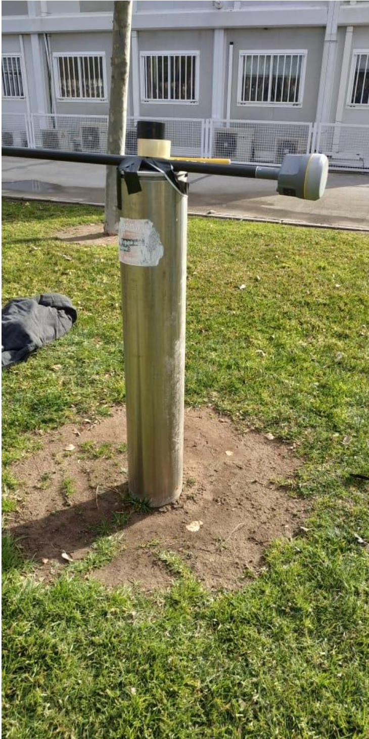
Ilustración 62, Receptor R10 colocado en horizontal sobre césped de la UPV
