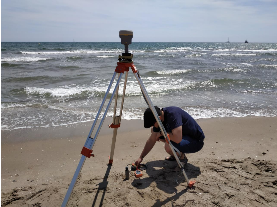
Ilustración 57, Colocación de la sonda a la altura del receptor.
