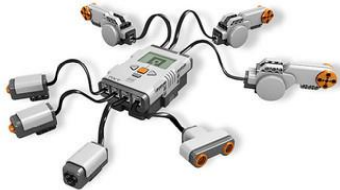
Figura 5.9 "ladrillo" NXT con los sensores y los actuadores conectados [15]
