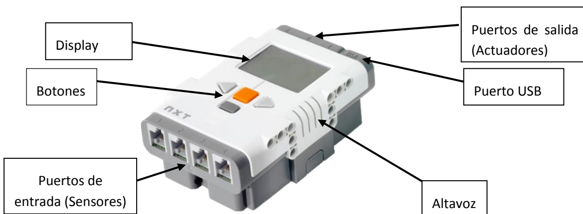
Figura 5. 2 "Ladrillo" inteligente NXT y sus componentes [11]
