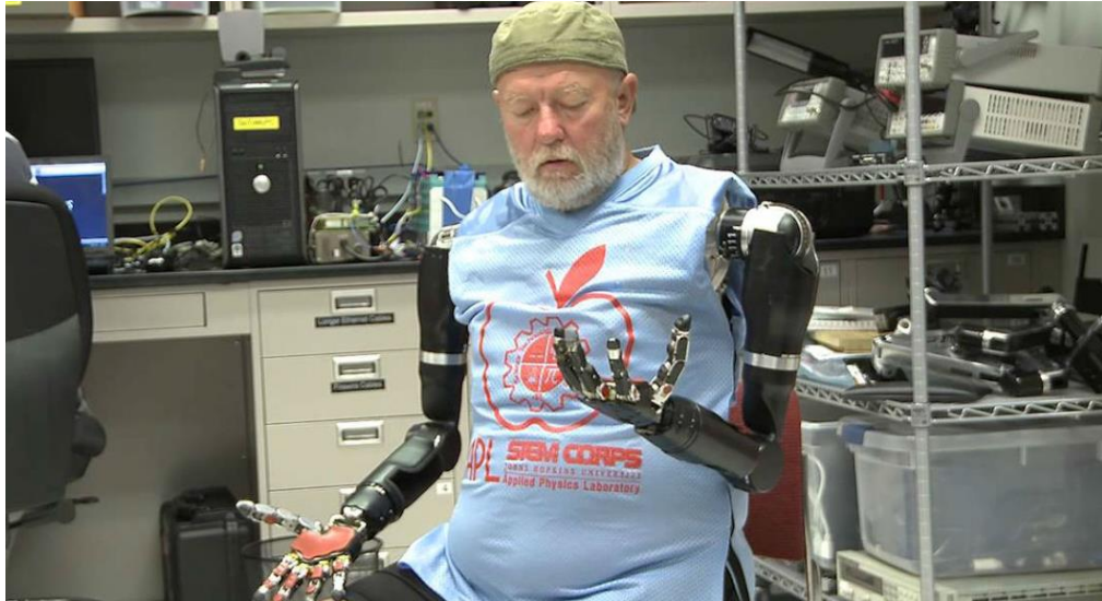
Figura 13: Prótesis actual activada mediante estímulos nerviosos [12]
