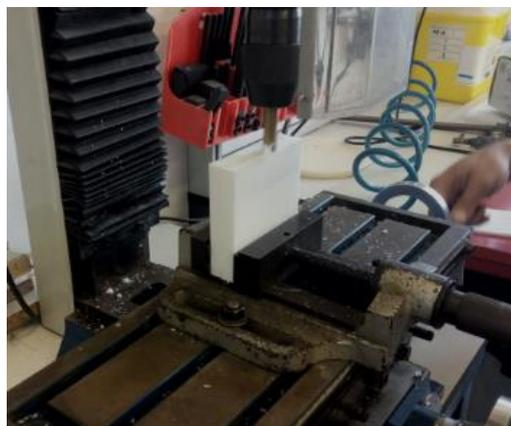
Fig 25. Fresado del teflón. Fuente: Propia
