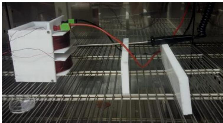
Fig 41. Ensayo térmico. Posicionamiento de la sonda en el biorreactor. Fuente: Propia
