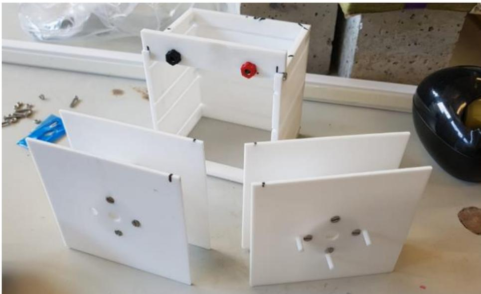
*Fig 27. Bastidor mecanizado y montado, con las bobinas insertadas. Fuente: Propia*
