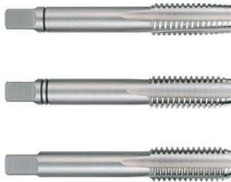
*Fig 26. Machos de roscar. Con cada macho, se va roscando cada vez más el material (apreciar diferencia entre valle y cresta de cada macho). Fuente: Ruko*
