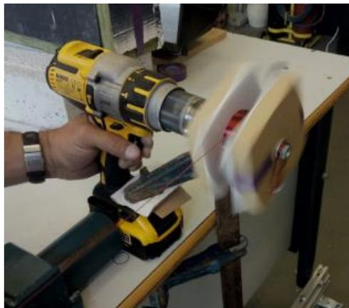
*Fig 29. Bobinado de las bobinas con un taladro eléctrico. Fuente: Propia*
