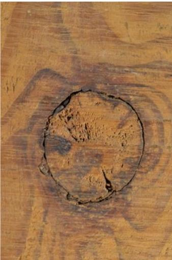
Fig.23. Fotografía de detalle de un nudo
