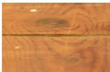
Fig.13. Detalle de la marca de aserrado
