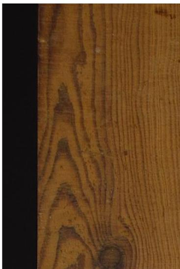
Fig.10. Detalle de la dirección de la veta
