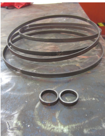
Fig. 35. Obra propia, proceso de construcción de la esfera. Soldadura de cierre de circunferencias inicial
