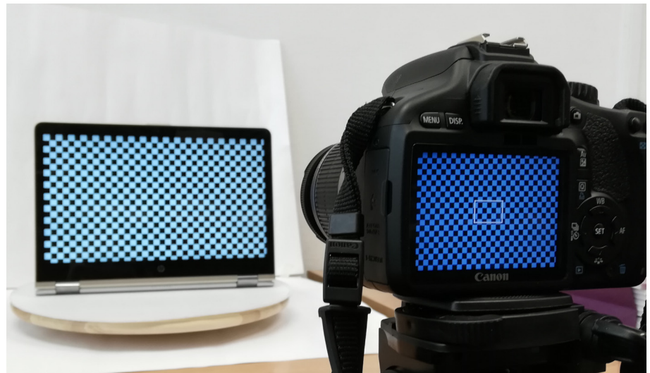
Fig.21. Calibración de la cámara mediante el uso de retícula.
