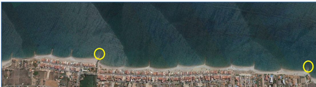
Ilustración 17: Espigones de control. Fuente: Elaboración propia.
